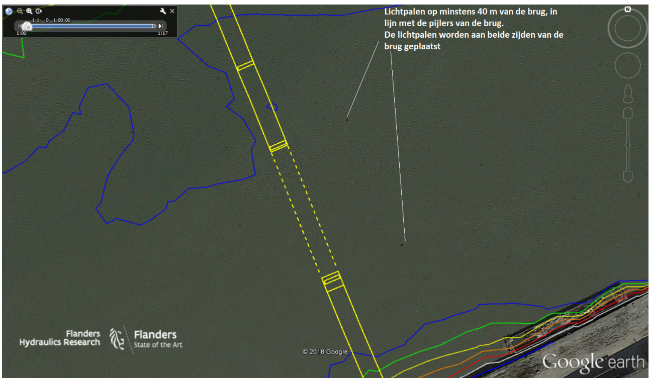
Figuur 17 – Illustratie van de toevoeging van lichtpalen bij de gele variant
