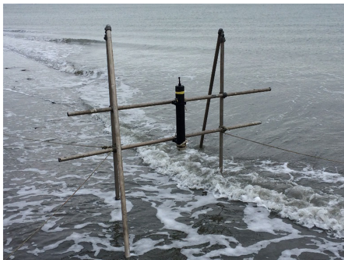
Figuur 3: Aquadopp ® (linksboven) en hoogfrequente druksensor (linksonder) ingegraven in slik (links) en hoogfrequente, neerwaarts gerichte Aquadopp ® bij de Hoge Springer (rechts)
