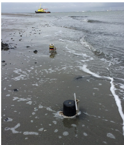
Figuur 3: Aquadopp ® (linksboven) en hoogfrequente druksensor (linksonder) ingegraven in slik (links) en hoogfrequente, neerwaarts gerichte Aquadopp ® bij de Hoge Springer (rechts)
