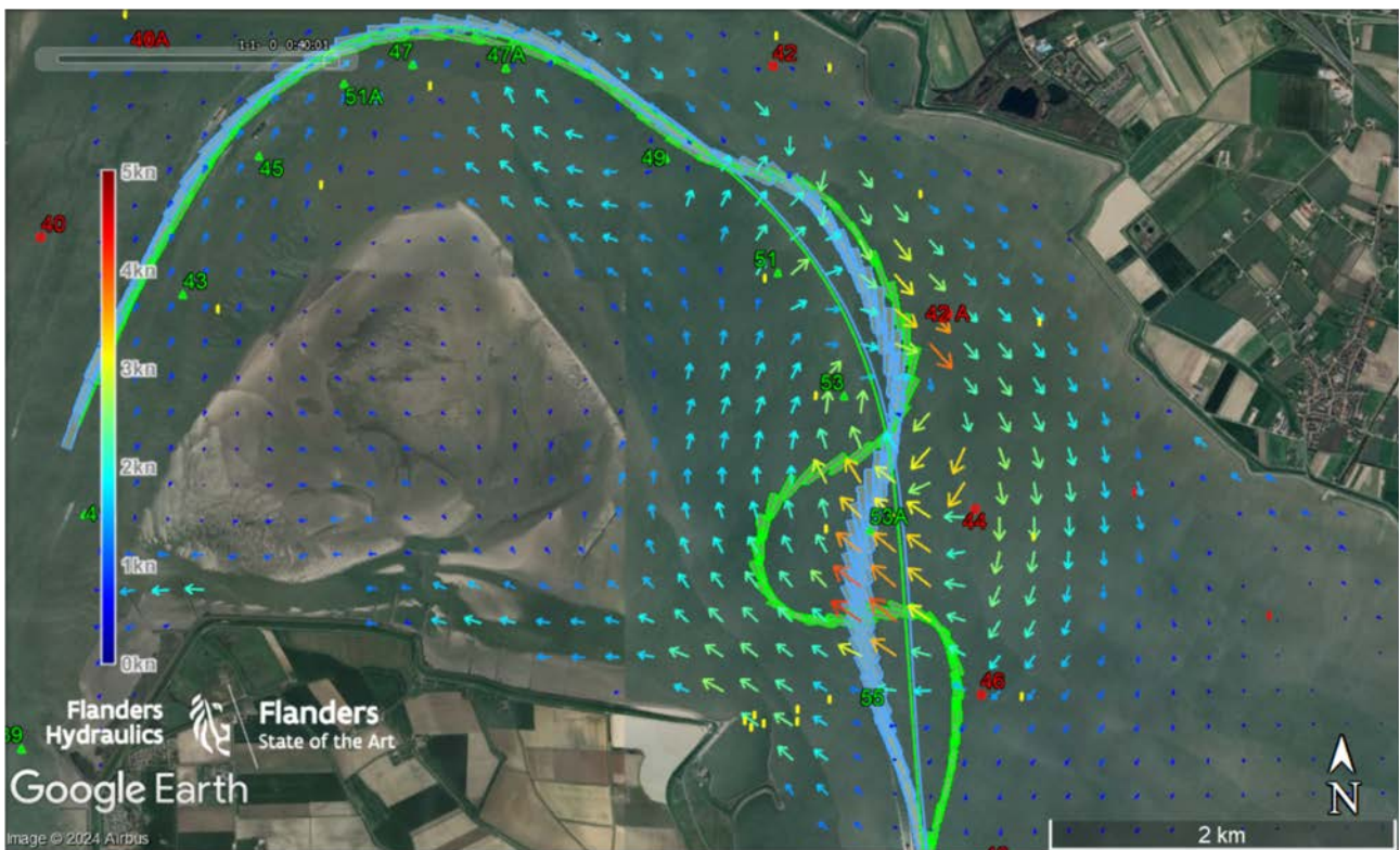
Figuur 49 – Simulatietraject opvarende ULCS (blauwe contour) en Panamax (groene contour) bij stroming 06
