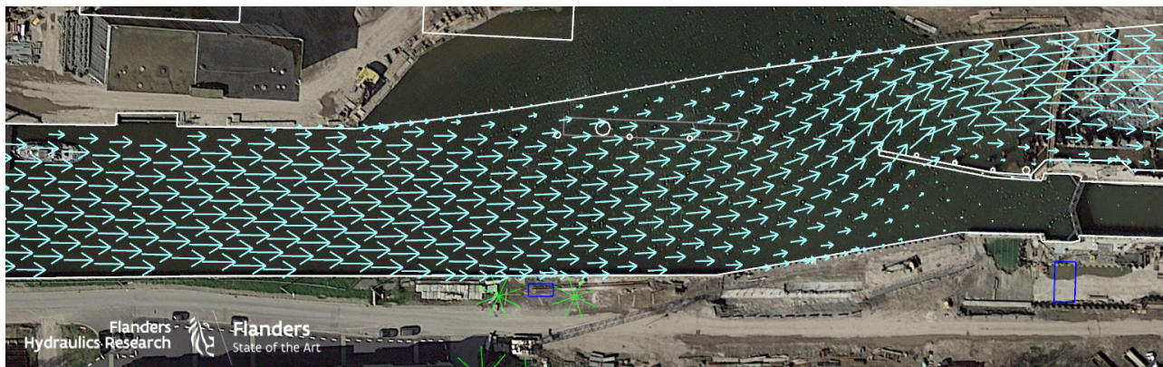
Figuur 21 – Stroompatroon ter hoogte van bovenhoofd
