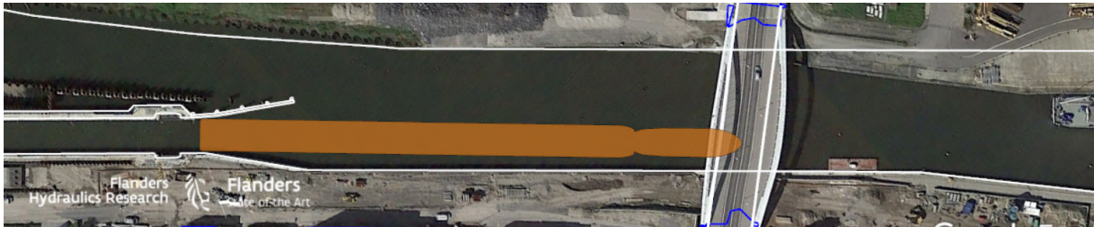
Figuur 30 – Sluisinvaart benedenpand door Vb duwkonvooi in geval van boegschroefgebruik (simulatie 031)
