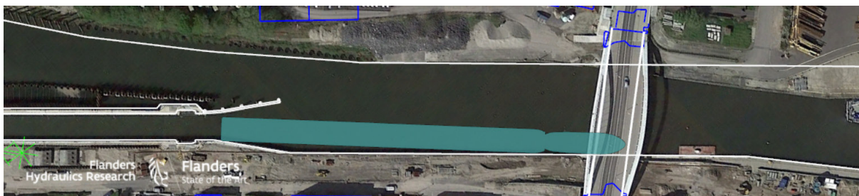
Figuur 29 – Sluisvaart benedenpand door Vb duwkonvooi waarbij boeg en achterzijde bakken langs rechteroever glijden (simulatie 030)
