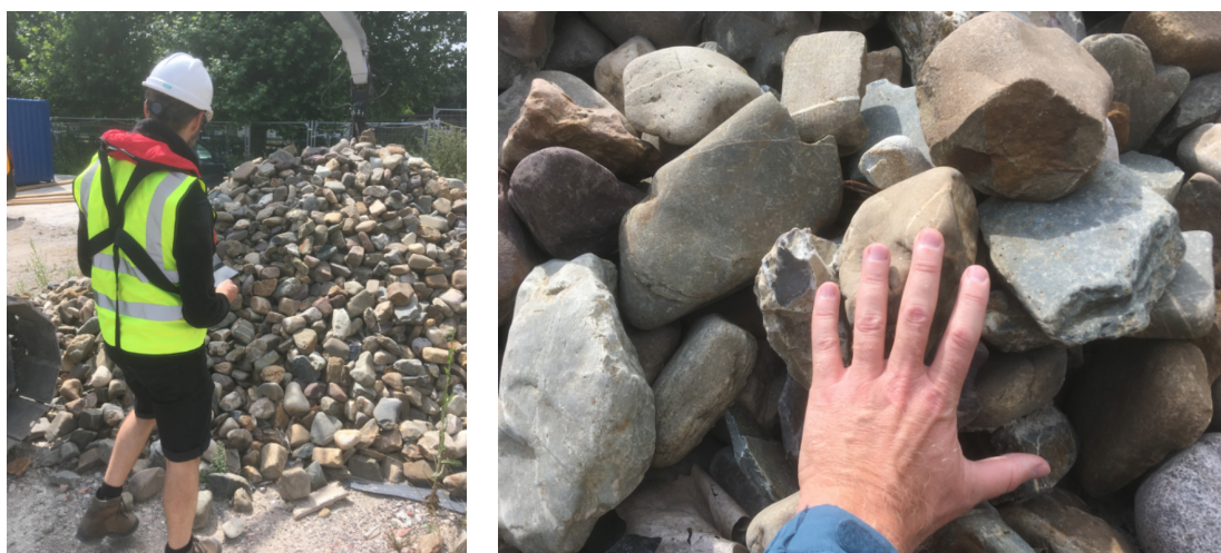
Figuur 32 – Voorbeeld toepassing rolstenen 90/130 mm voor in vispassage Sint-Baafs-Vijve
