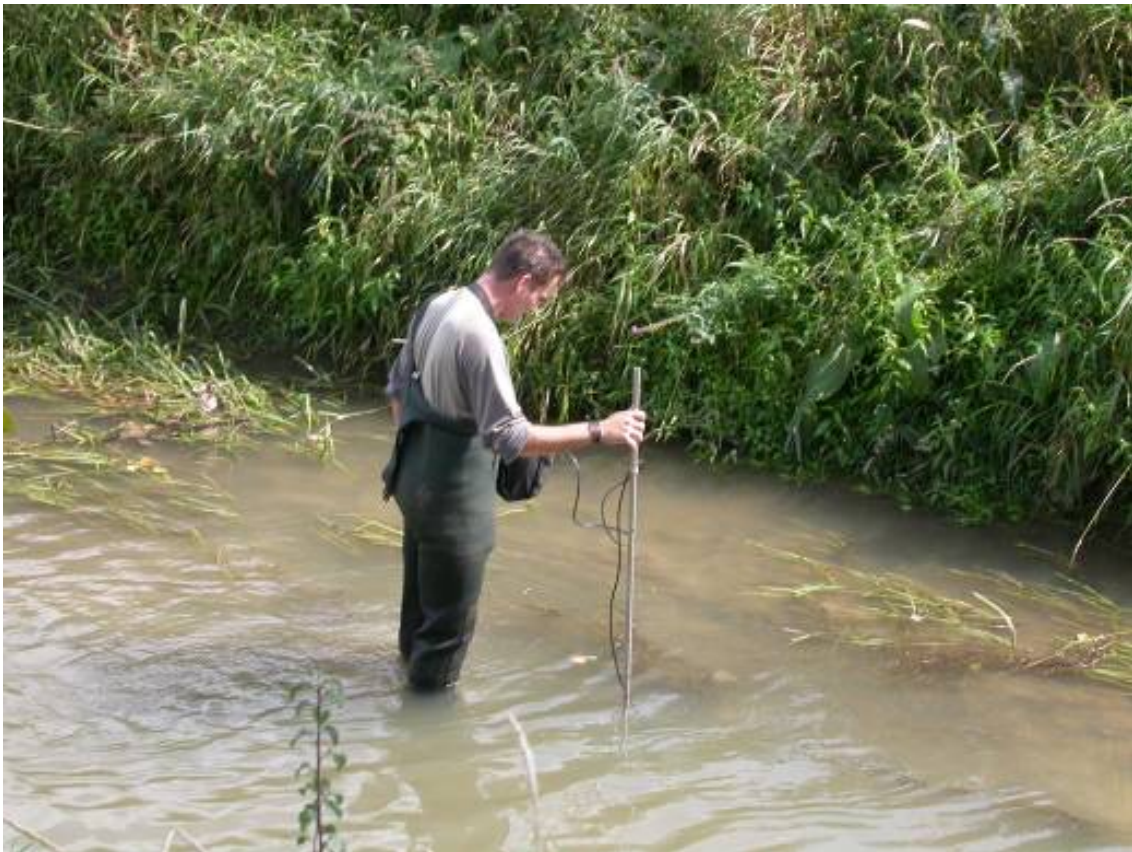
Figuur 7. Habitatopmeting met behulp van een stroomsnelheidsmeter.
