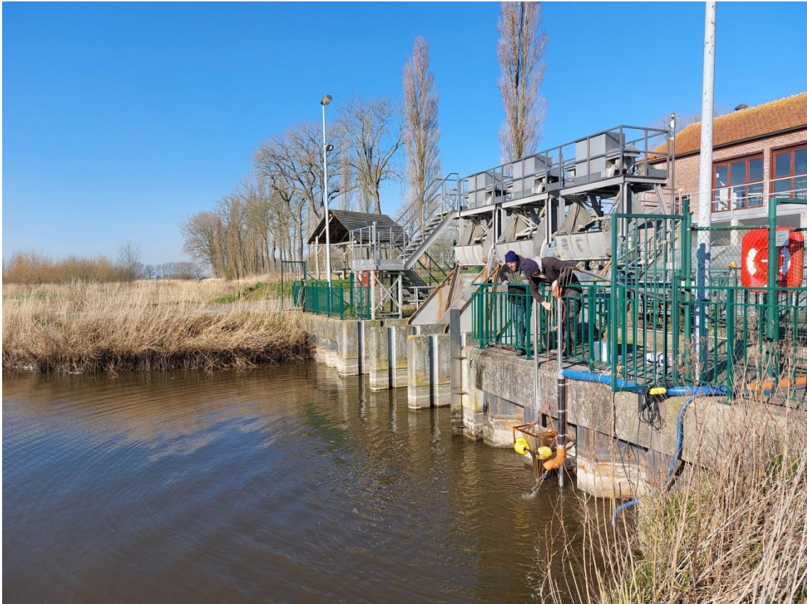
Figuur 11 Hier komt de afvoerbuis uit in de polder. De opvangbak wordt op de foto omhoog getrokken om de vangst te kunnen bekijken.
