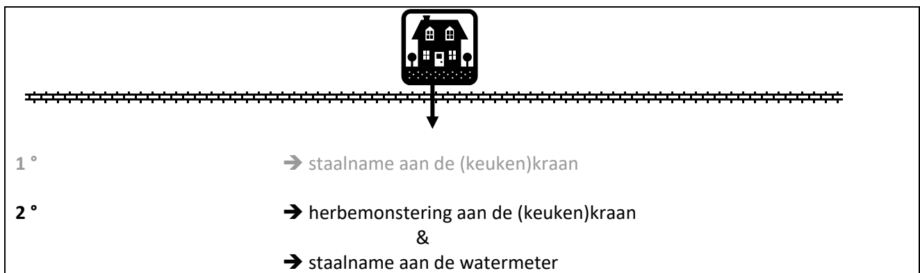
figuur 3: schematische weergave van de 'tweemonsterprocedure' voor de herbemonstering bij het vaststellen van een normoverschrijding aan de kraan
