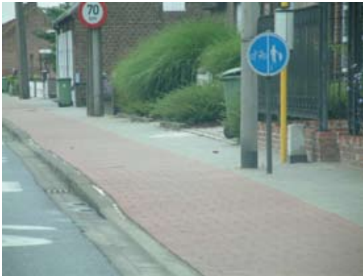
Fig. 2.1.3b Een gemengd (brom-)fiets-wandelpad kan alleen op routes met een zeer lage intensiteit .
