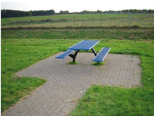
Fig. 2.5.1g Picknicktafels met een onderrijdbare kopse kant zijn het meest ideaal. Deze meubels zijn bruikbaar voor personen in een rolstoel, buggy's kunnen aangeschoven worden,... Het stoort ook niet wanneer deze onderrijdbare plaats niet gebruikt wordt: er zijn geen onnodig open plekken aan tafel.
