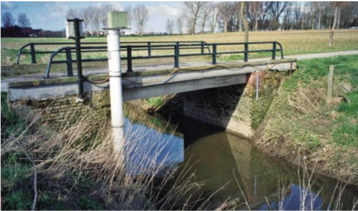
Linnigraaf op de Krekelbeek aan de Krekelbekerstraat bij lage afvoer (foto boven) en bij hoge afvoer (foto onder).
