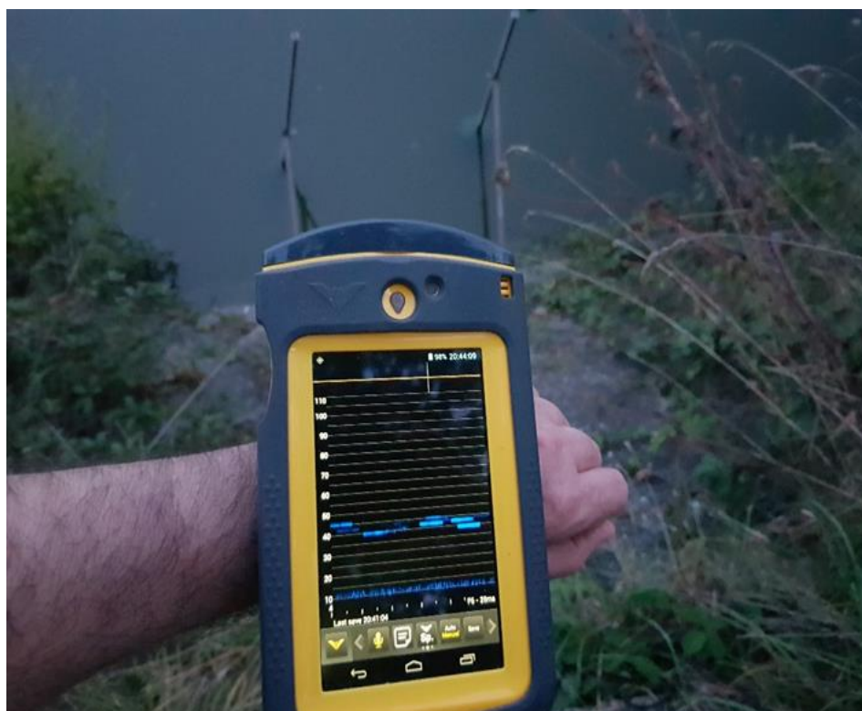
Figuur 10. Gebruikte Anabat Walkabout batdetector, waarmee op korte afstand de ca. 40 kHz geluiden van de ultrasone toestellen goed meetbaar waren.
