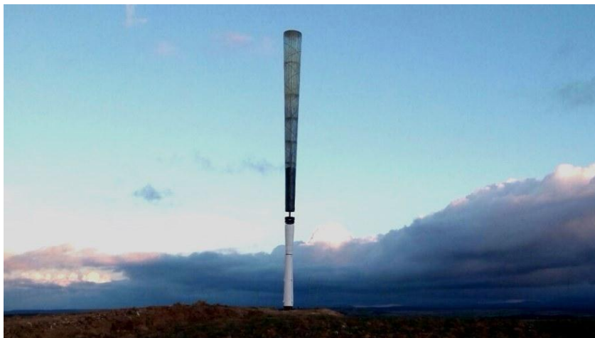
Figuur 19 Nieuw type windturbine zonder wieken op basis van vortex technologie
