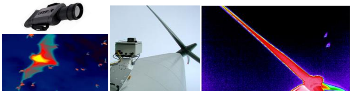
Figuur 24 Manueel en automatisch visuele metingen van vogels en vleermuizen met infrarood warmtebeeldkijker.
