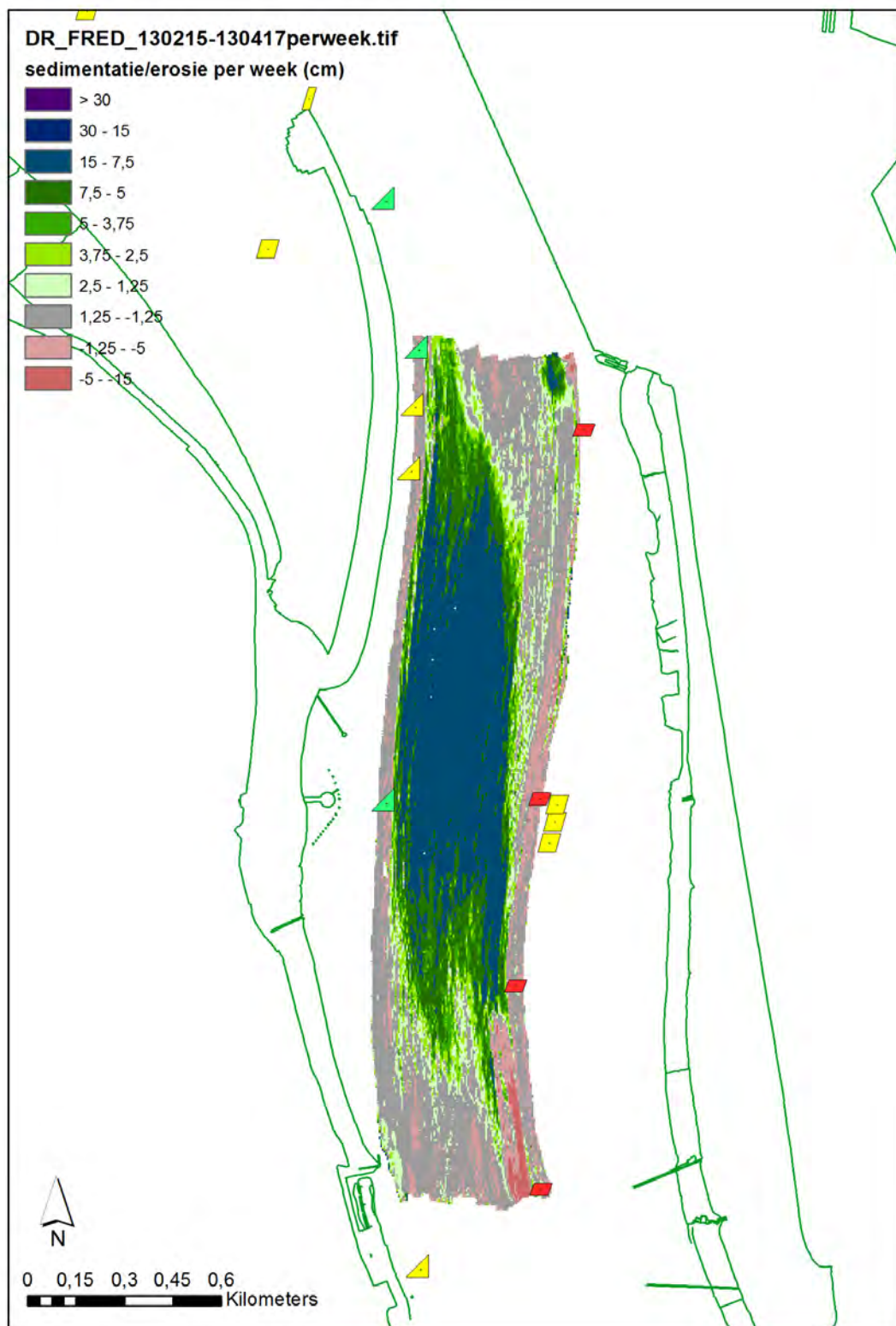
Figuur A 67 – Wekelijkse sedimentatie- erosie ter hoogte van de drempel van Frederik voor de periode 15/2/2013 en 17/4/2013
