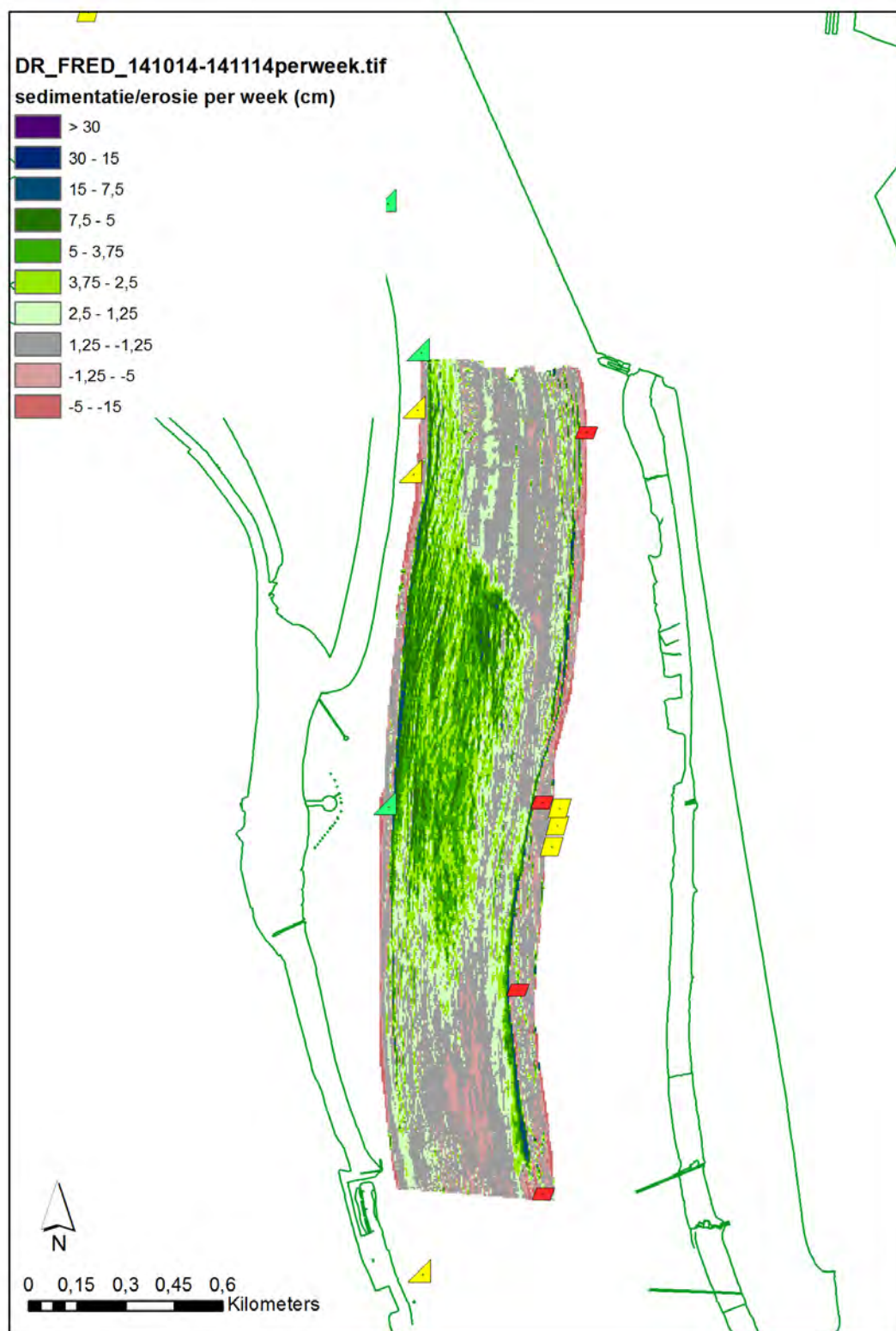
Figuur A 82 – Wekelijkse sedimentatie- erosie ter hoogte van de drempel van Frederik voor de periode 14/10/2014 en 14/11/2014
