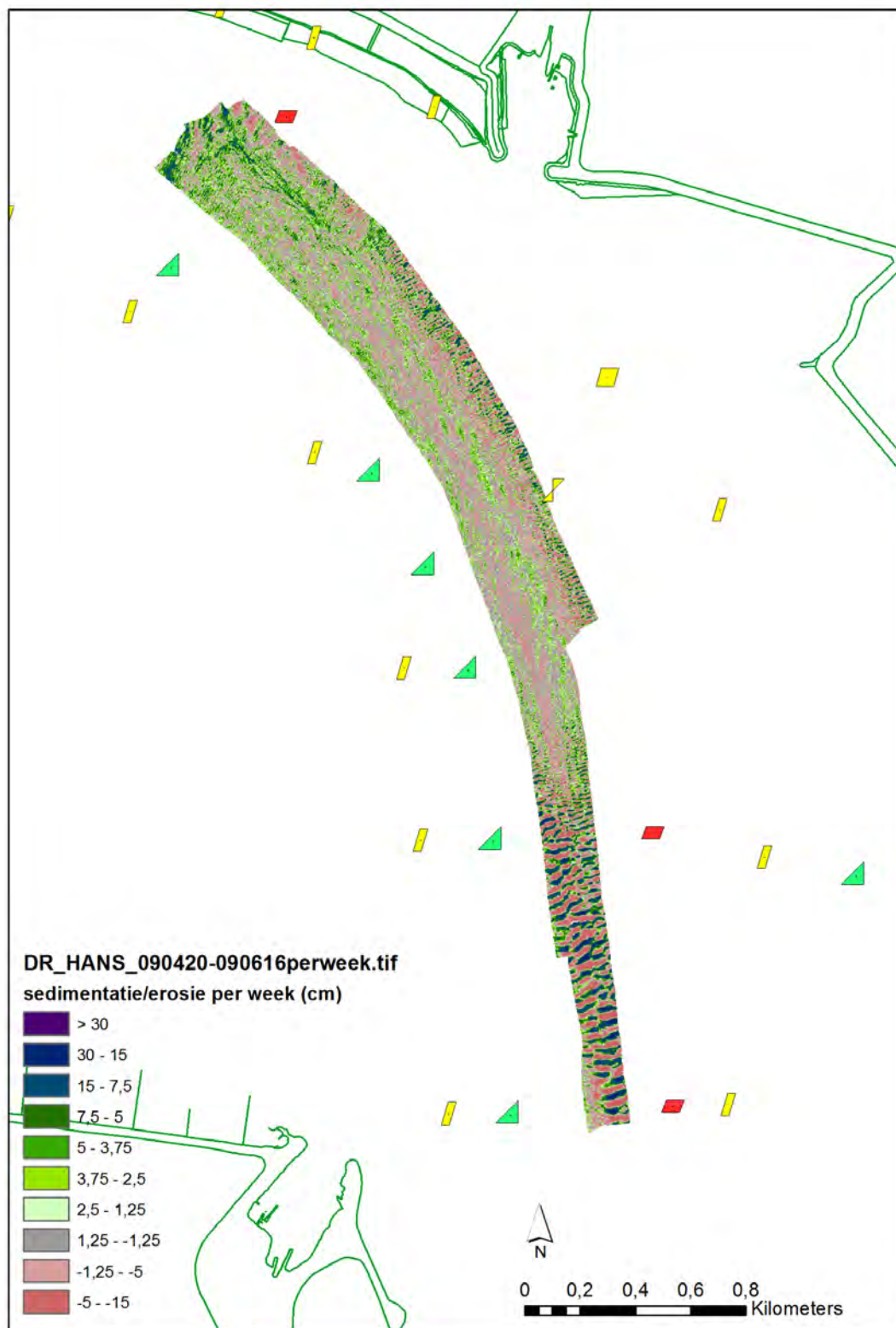
Figuur A 41 – Wekelijkse sedimentatie- erosie ter hoogte van de drempel van Hansweert voor de periode 20/4/2009 en 16/6/2009
