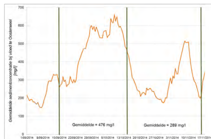
Figuur 19 –Verloop van gemiddelde sediment concentratie tijdens vloed te Oosterweel (bovenste sensor) (verticale lijnen = peiling)
