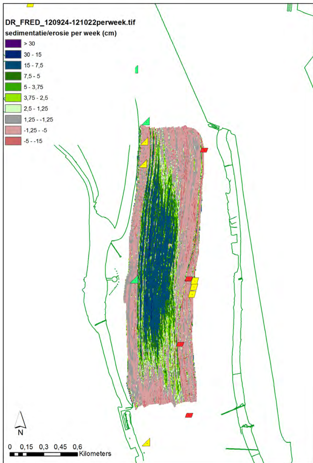
Figuur A 79 – Wekelijkse sedimentatie- erosie ter hoogte van de drempel van Frederik voor de periode 24/9/2012 en 22/10/2012
