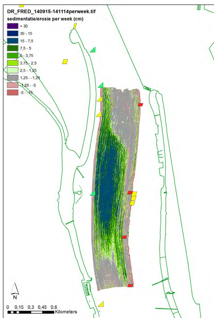
Figuur 17 – Wekelijkse sedimentatie- erosie ter hoogte van de drempel van Frederik voor de periode 15/09/2014 tot 14/11/2014
