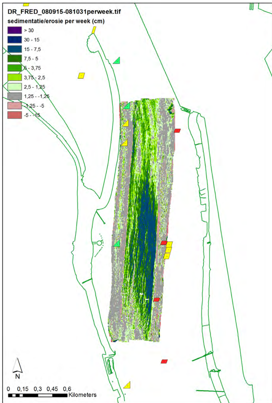
Figuur A 61 – Wekelijkse sedimentatie- erosie ter hoogte van de drempel van Frederik voor de periode 15/9/2008 en 31/10/2008
