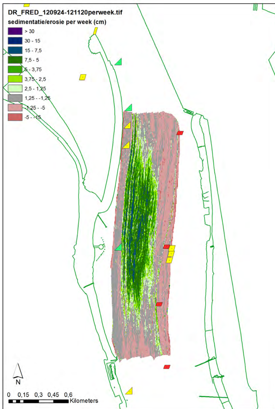
Figuur A 66 – Wekelijkse sedimentatie- erosie ter hoogte van de drempel van Frederik voor de periode 24/09/2012 en 20/11/2012
