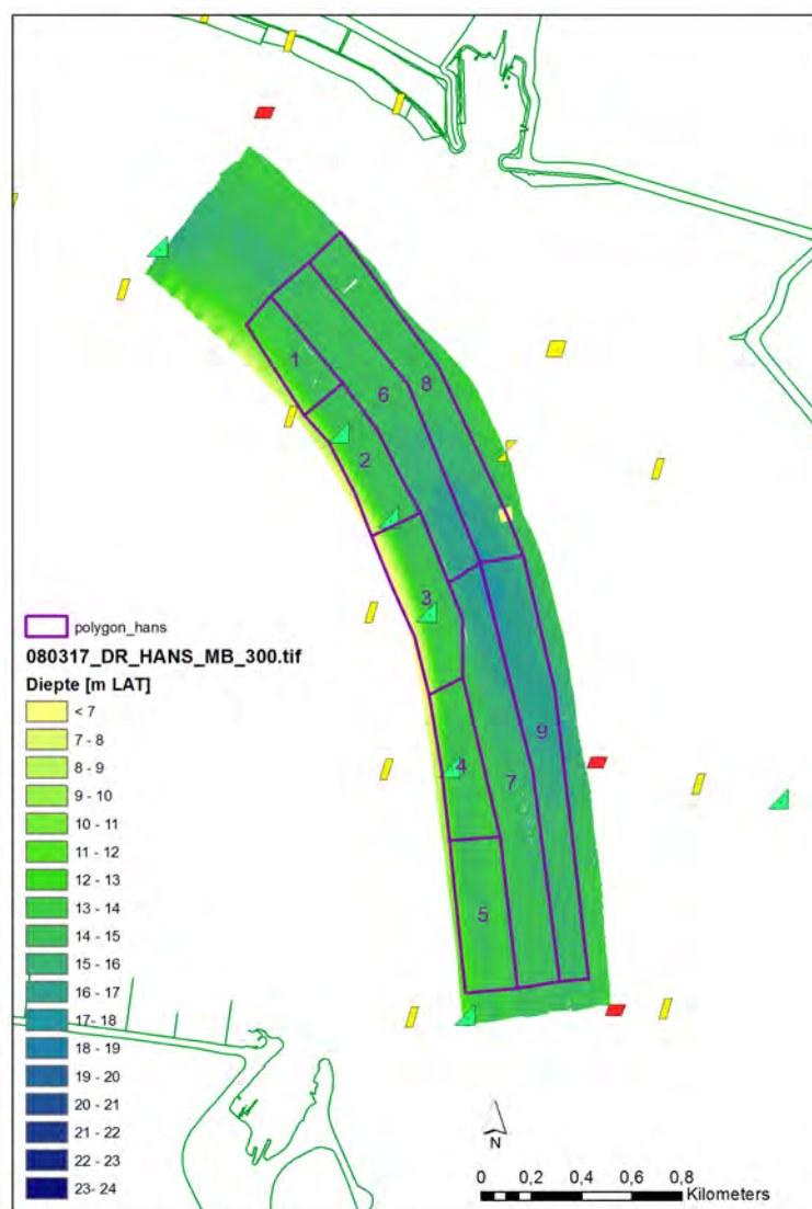
Figuur 6 – Ligging polygonen voor berekening van de gemiddelde sedimentatiesnelheid op de drempel van Hansweert
