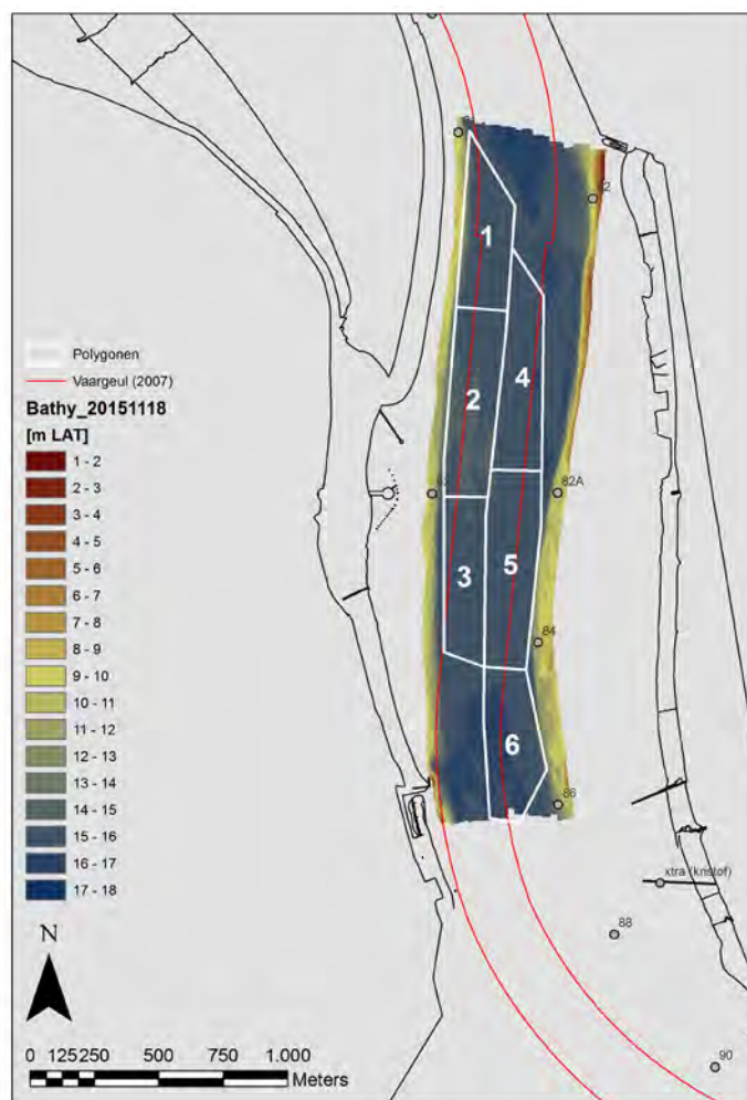
Figuur 20 – Ligging polygonen voor berekening van de gemiddelde sedimentatiesnelheid op de drempel van Frederik
