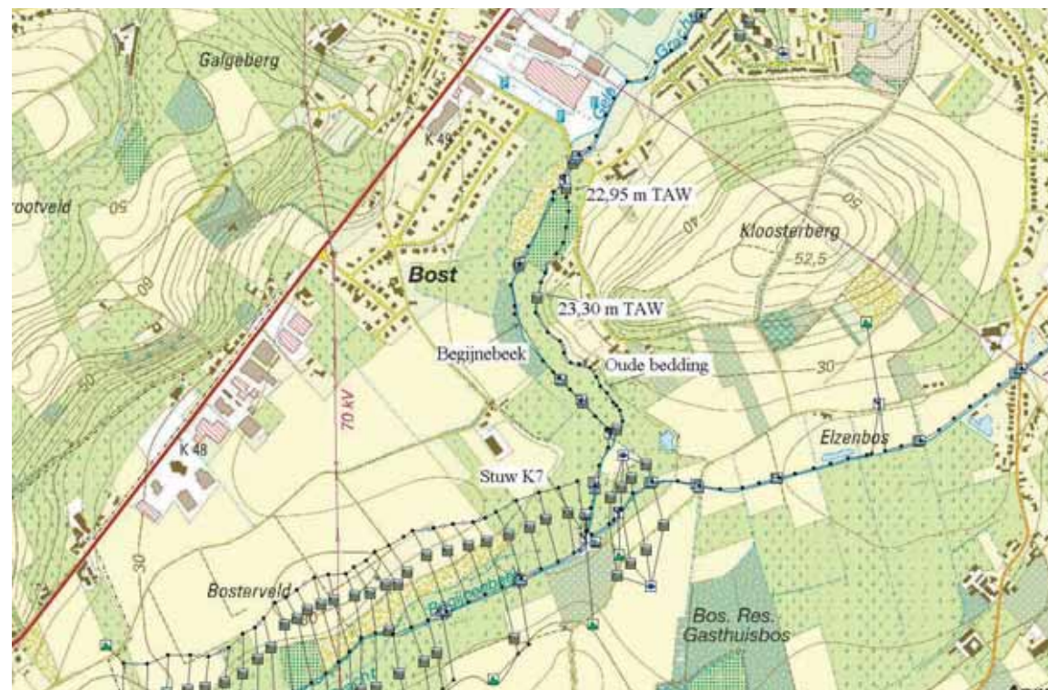
Landkaartje van scenario 1 waarop ook de knopen van het hydraulisch model afgebeeld staan. Bemerkt de dwarsprofielen minimum om de 50 meter alsmede de kunstwerken en de overstroombare vallei.
