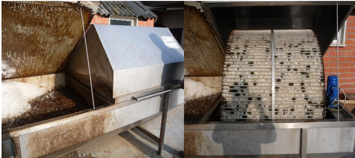
Figuur 9: Voorbeeld van een denitrificator.
