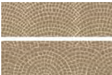
Illustratie van een schubben- (boven) en waaierverband (onder)
