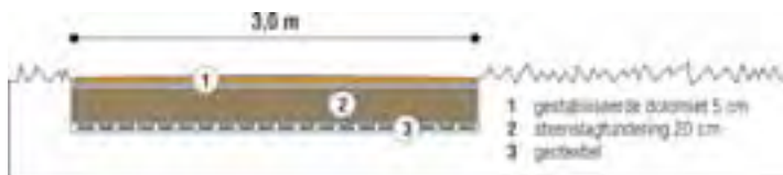
Opbouw van een pad van gecementeerde dolomiet
