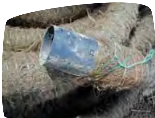
Illustratie van een drainagebuis met een filter uit kokos
