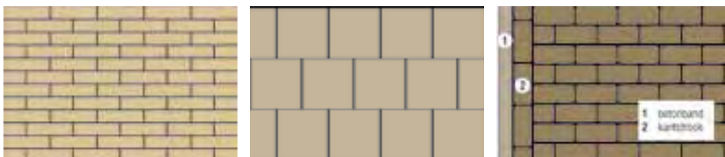
Illustratie van een halfsteensverband met verschillende types en formaten elementen (bv. gebakken straatstenen, betonklinkers, natuursteenkeien, ...)
