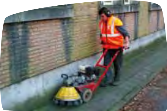
Borstelen met een zelftrekkende machine Foto: Stad Gent
