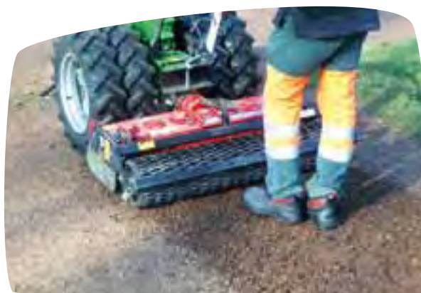
Oppervlaktebewerking met een rotoreg Foto: Stad Gent
