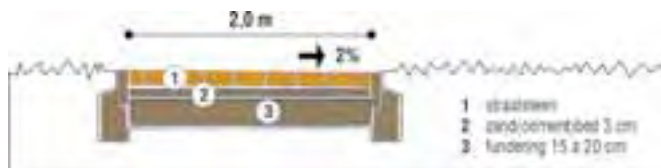
Opbouw van een pad van klassieke straatstenen
