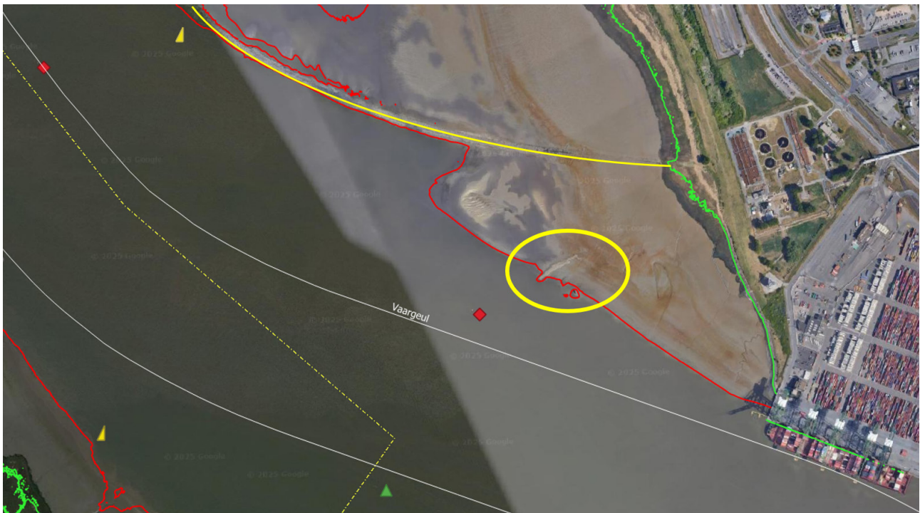
Figuur 6 – Luchtfoto studiegebied met hoogwaterlijn (groene contour) en laagwaterlijn (rode contour) bij springtij, strekdam (gele lijn), en blootliggende stortsteen bescherming (gele cirkel).
