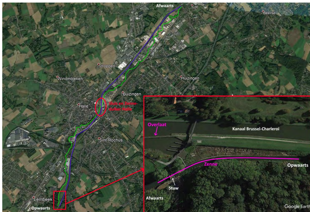
Figuur 23 – Stuw en overlaat op de Zenne te Lembeek
