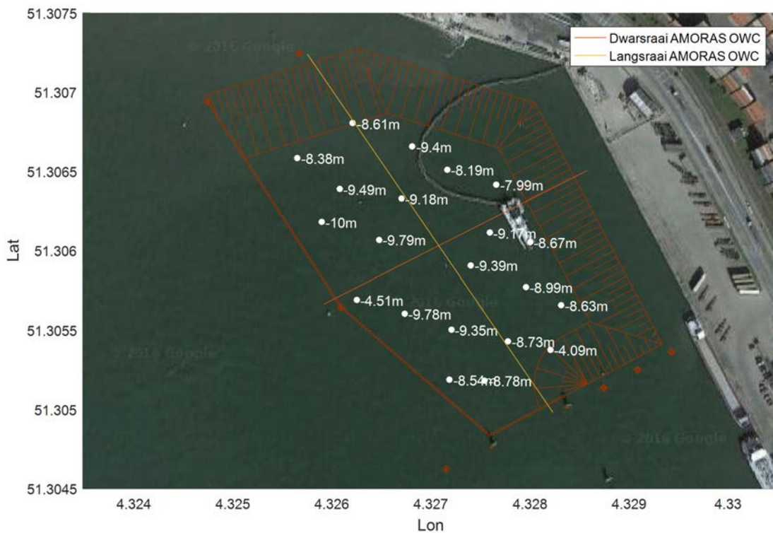
Figuur 37: RheoTune peilingen 28/09/2015, diepte van de peilingen in mTAW.
