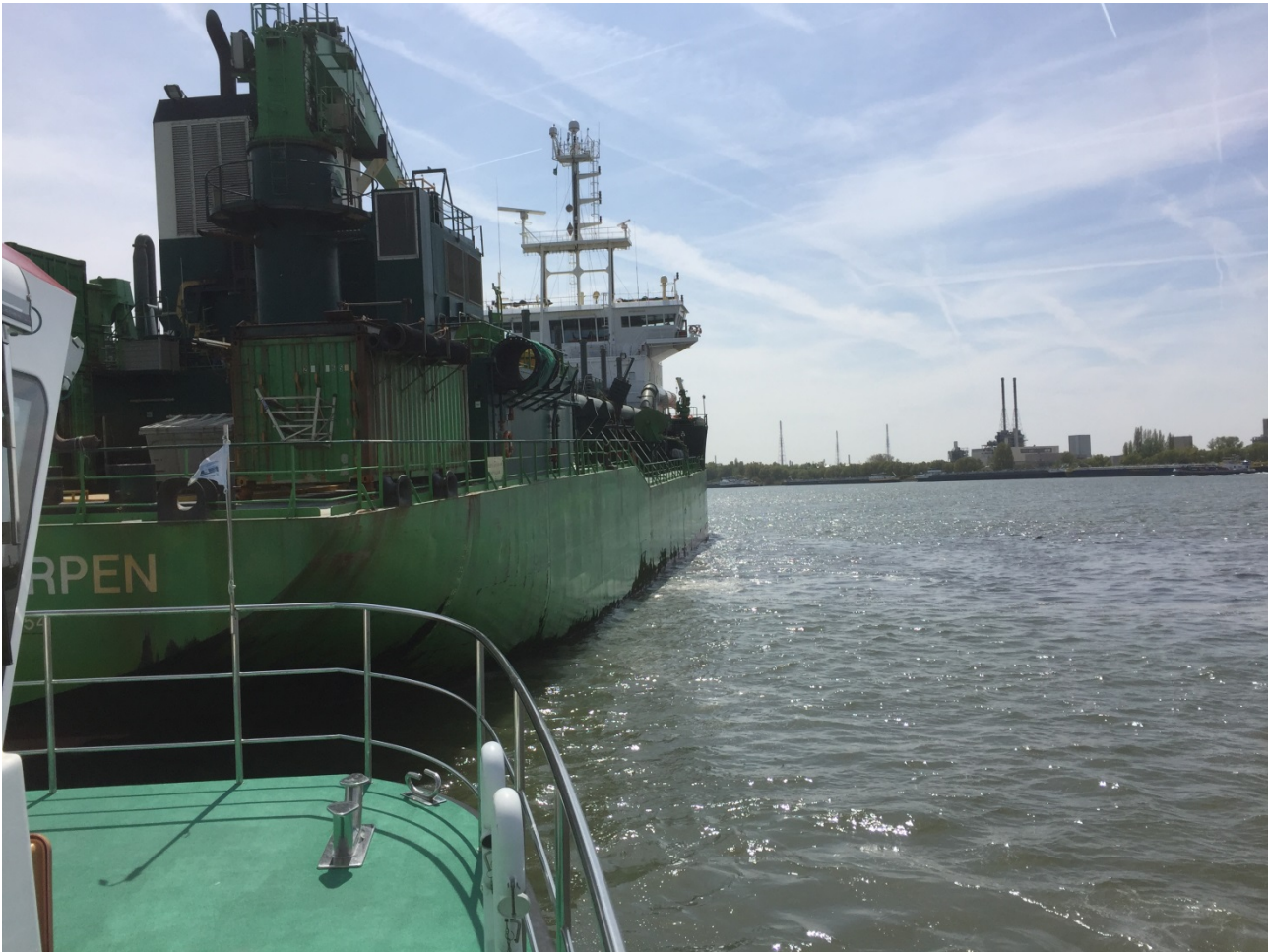
Figuur 22: Positioneren van de Pierre Petit boven de losplaats vlak na het kleppen
