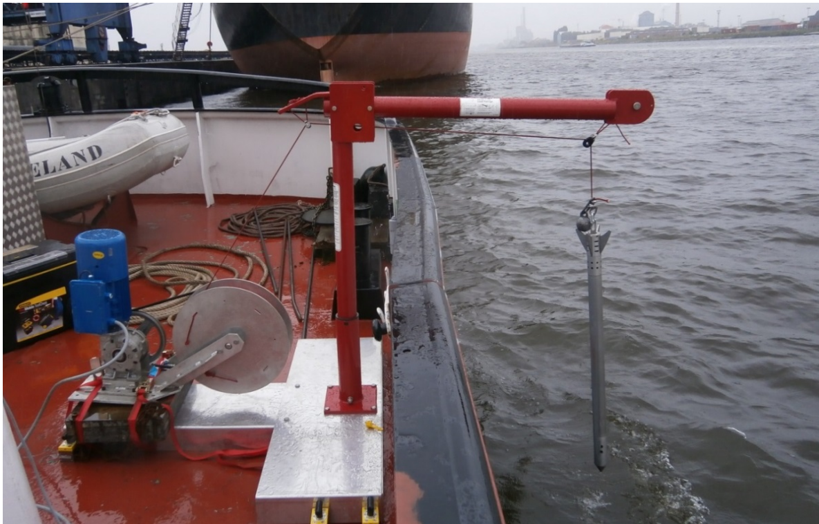
Figuur 32: GraviProbe meetinstrument ontwikkeld door dotOcean (bron: GHA).
