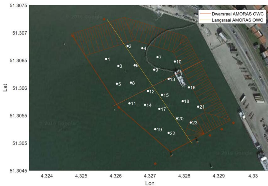
Figuur 74: Positie van de theoretische raaien waarop de gemeten densiteiten (RheoTune® prikken, aangeduid in de figuur) geïnterpoleerd worden.
