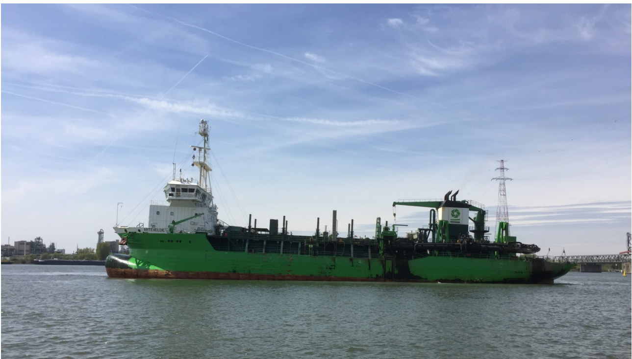
Figuur 13: MS Artevelde tijdens het lossen van 5400 m 3 baggerspecie
