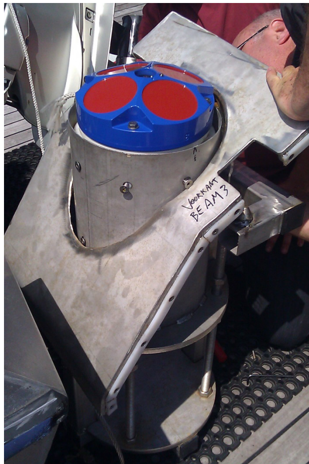
Figuur 33: ADCP klaargemaakt voor montage in de romp (bakboord) van de Pierre Petit
