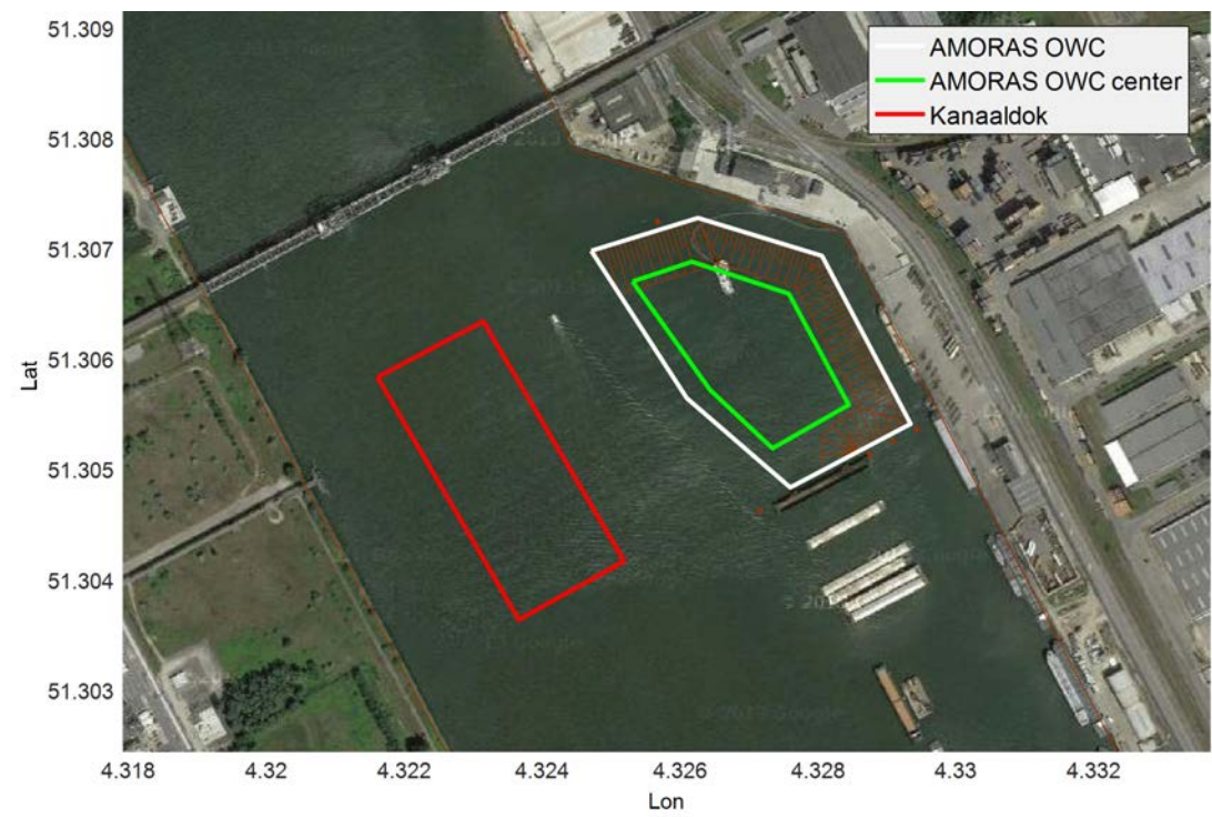
Figuur 36: Definitie polygonen voor de berekening van sediment volumes (AMORAS OWC), gemiddelde diepte centraal in de cel (AMORAS OWC center) en gemiddelde diepte Kanaaldok B1 (Kanaaldok)
