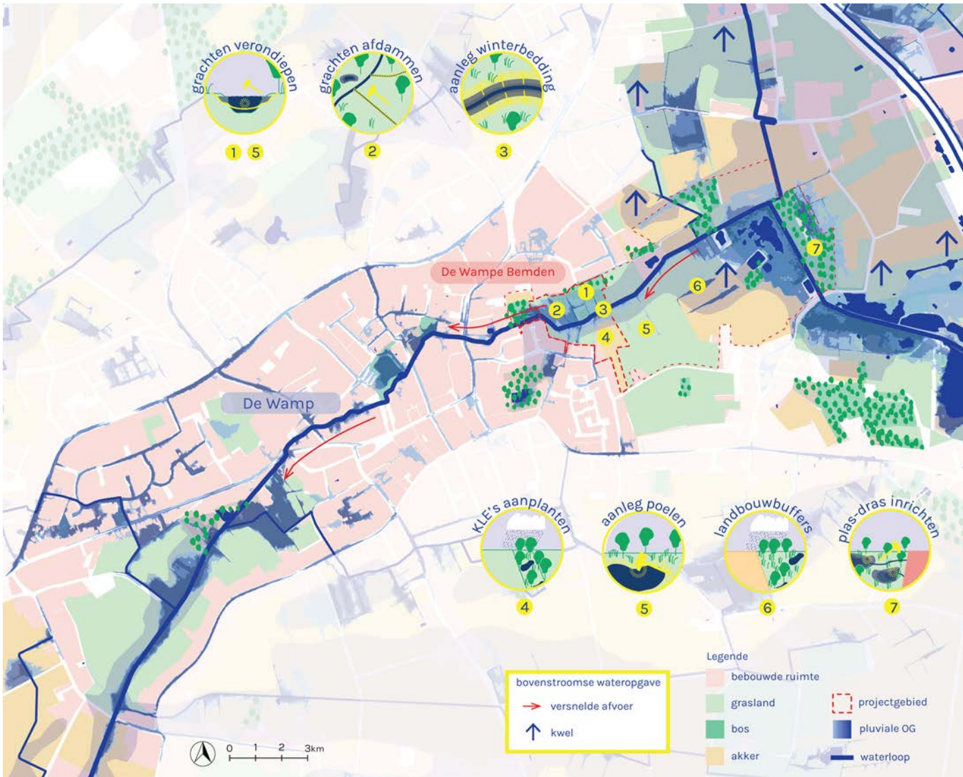
Overzichtskartaal: de Wampe Bemden vernatten om water bovenstrooms langer vast te houden.
