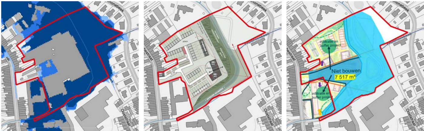
Huidige toestand: verlaten industrie in overstromingsgebied. Het oorspronkelijke ontwerp door de ontwikkelaar voorzag te weinig ruimte voor buffering. De waterstudie bracht het nodige buffervolume in kaart. © Leiedal
