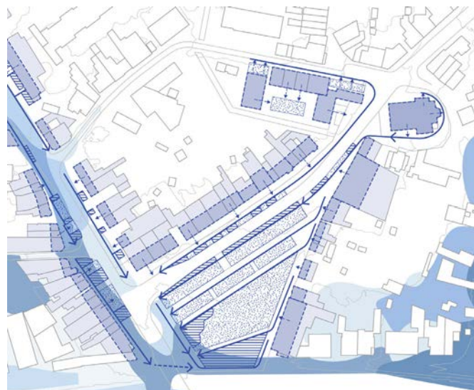
De waterlijnen brengen het water vanuit de omliggende straten naar het hemelwaterplein. © Atelier Horizon
