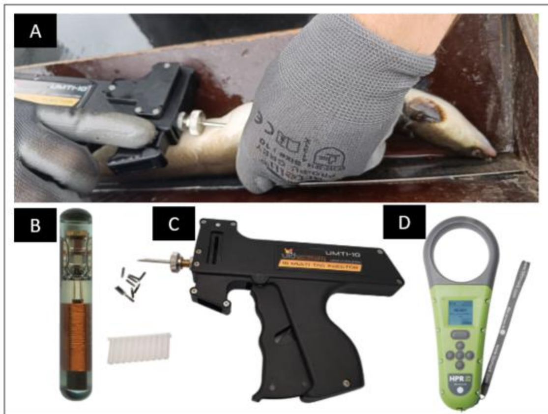
Figuur 9: (A) Inbrengen van PIT-tag met schietpistool (B) PIT-tag (Passive Integrated Transponder) of 'zendertje' met geïntegreerd circuit en koperen winding (C) Schietpistool voor het inbrengen van de PIT-tag (Multi PIT Tag Injector (UID)) met vooraf geladen PIT-tagcartridge (D) HPR Lite PIT Tag Reader (Biomark) waarmee elke PIT-tag uitgelezen werd.
