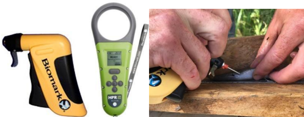
Figuur 40 (links) Schietpistool voor het inbrengen van de PIT-tag (Biomark); (midden) Reader voor aanwezige PIT-tags waar te nemen (Biomark); (rechts) inbrengen van PIT-tag met schietpistool.
