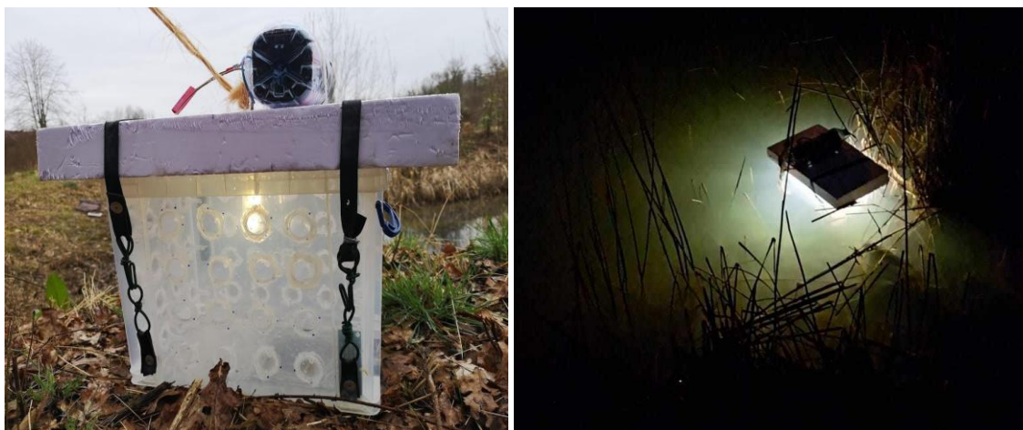
Figuur 30 De lichtvallen (nieuw model) voor het vangen van kwabaallarven.
