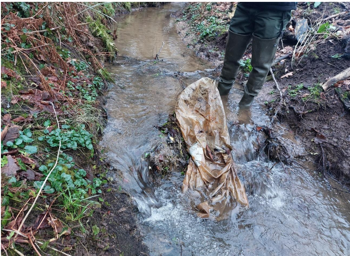
Figuur 65 De riffle op het zijbeekje aan de Loonbeekmolen was bedekt met sediment doordat er vuil was blijven hangen aan onze opstelling.
