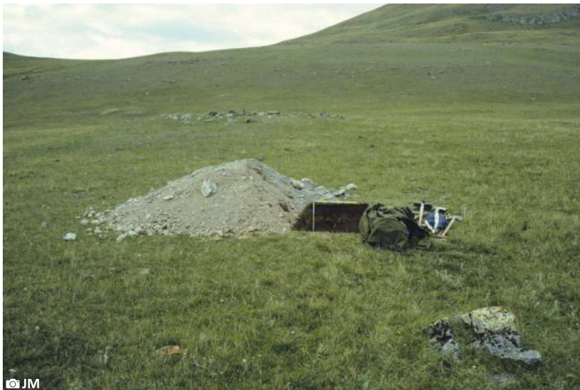
Fig. B94-B95: Een bodemprofiel wordt op een helling aangelegd met de lange zijde evenwijdig aan de helling. Het opgegraven materiaal wordt langs de lange zijde, ofwel links ofwel rechts, van het profiel opgeslagen - NIET aan de bovenkant, dit voor een optimale foto. Sebystei, Altai, Rusland.
