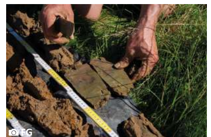
Fig. B76-B78: De boorkluiten worden volgens de diepte op het zeil gelegd (fig. B76). Daarna worden de kluiten in twee helften opengesneden om zicht te krijgen op het ongecontamineerde bodemmateriaal (fig. B77). Bij kleirijke horizonten zal het nodig zijn om de kluit met een mes in twee te snijden (fig. B78). Berg, Tongeren, provincie Limburg, België.
