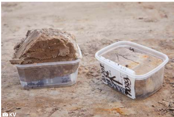
Fig. B115-B123: Werkwijze voor staalname van ongestoorde monsters. Eerst wordt de wand mooi afgeschrapt en geëffend en wordt de zone aangeduid waar de bemonstering moet gebeuren (fig. B115). Staalnamebakjes worden gelabeld en georiënteerd door een pijl op het recipiënt te tekenen (fig. B116). De grootte van het te nemen staal wordt afgepast en in de bodem gekrast (fig. B117). Met een mes wordt de oriëntatie van het bodemstaal met een pijl aangeduid, de 4 wanden van het staal worden voorzichtig met een mes zo diep mogelijk vrijgemaakt (fig. B118-B120). Het doosje wordt in de gleuven rond het staal geschoven en met een spatel wordt de achterkant van het bodemstaal verder losgemaakt (fig. B121). Het te veel aan materiaal wordt voorzichtig afgeschrapt. Het recipiënt, voorzien van een staalkaartje wordt afgesloten (fig. B122) en gestockeerd voor transport (fig. B123). Sint-Gillis-Waas, provincie Oost-Vlaanderen, België.
