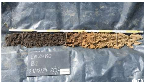
▲ Fig. B81: De boring voor het openleggen van de bodemkluiten.
