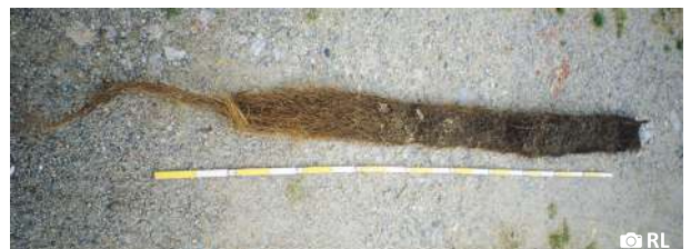
Fig. D105-D106: Het uittrekken van een 2,5 m lange 'vossenstaart', een wortelmasa, uit een draineringsbuis. Cap del Rec, Lles, Cerdanya, Spanje.
