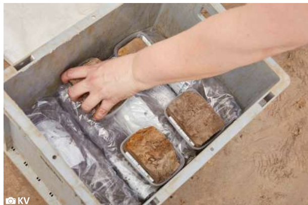
Fig. B115-B123: Werkwijze voor staalname van ongestoorde monsters. Eerst wordt de wand mooi afgeschrapt en geëffend en wordt de zone aangeduid waar de bemonstering moet gebeuren (fig. B115). Staalnamebakjes worden gelabeld en georiënteerd door een pijl op het recipiënt te tekenen (fig. B116). De grootte van het te nemen staal wordt afgepast en in de bodem gekrast (fig. B117). Met een mes wordt de oriëntatie van het bodemstaal met een pijl aangeduid, de 4 wanden van het staal worden voorzichtig met een mes zo diep mogelijk vrijgemaakt (fig. B118-B120). Het doosje wordt in de gleuven rond het staal geschoven en met een spatel wordt de achterkant van het bodemstaal verder losgemaakt (fig. B121). Het te veel aan materiaal wordt voorzichtig afgeschrapt. Het recipiënt, voorzien van een staalkaartje wordt afgesloten (fig. B122) en gestockeerd voor transport (fig. B123). Sint-Gillis-Waas, provincie Oost-Vlaanderen, België.
