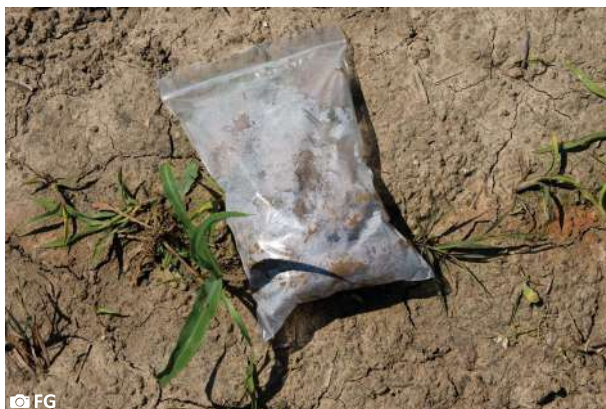
Fig. B105: Eens het bodemstaal is genomen, wordt het zo snel mogelijk bewaard in een koelbox. Het staal laten liggen in de zon, veroorzaakt opwarming van het bodemstaal en condensatie in de plastic zak wat de (micro)biologische activiteit in het bodemstaal versnelt.
