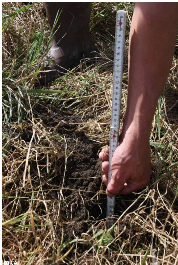
Fig. B79-B80: Met een tweede vouwmeter wordt regelmatig de boordiepte gecontroleerd (fig. B79). De gemeten boordiepte wordt vergeleken met het opgeboorde materiaal, desnoods wordt het opgeboorde materiaal samengedrukt of uitgespreid om overeen te komen met de effectieve boordiepte (fig. B80).
