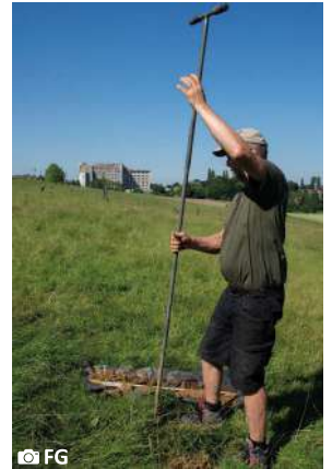
Fig. B70-B73: De boor wordt ongeveer 360° in de grond gedraaid, gevolgd door een kwartdraai terug. Erna kan de boor uit de grond getrokken worden. Berg, Tongeren, provincie Limburg, België.
