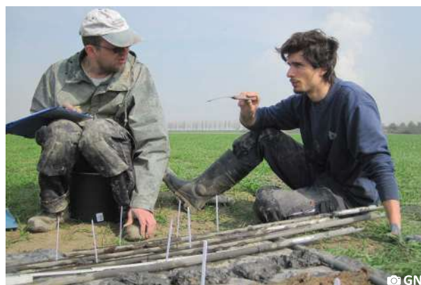
Fig. B85-B88: Bij diepe boringen is het sterk aangeraden om met meerdere mensen te zijn om de boor in de grond te krijgen (fig. B85) en er weer uit te halen (fig. B86). Het boorstaal in de guts wordt schoon afgesneden met een mes (fig. B87), en vervolgens kan de beschrijving van de boring beginnen (fig. B88). Overleg in het veld is uiterst belangrijk voor een optimale uitvoering en interpretatie. Saeftinghe, provincie Oost-Vlaanderen, België.
