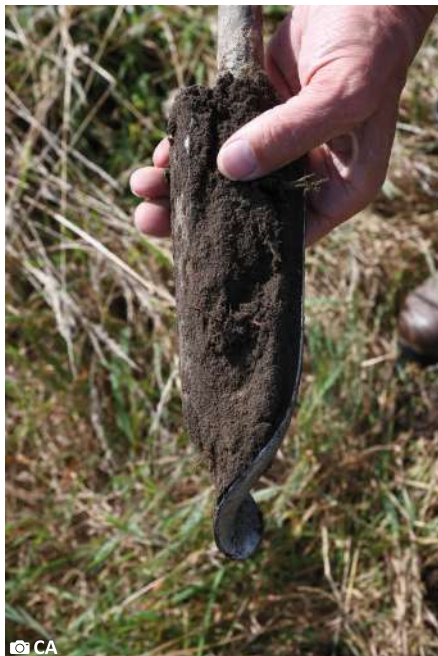
Fig. B70-B73: De boor wordt ongeveer 360° in de grond gedraaid, gevolgd door een kwartdraai terug. Erna kan de boor uit de grond getrokken worden. Berg, Tongeren, provincie Limburg, België.
