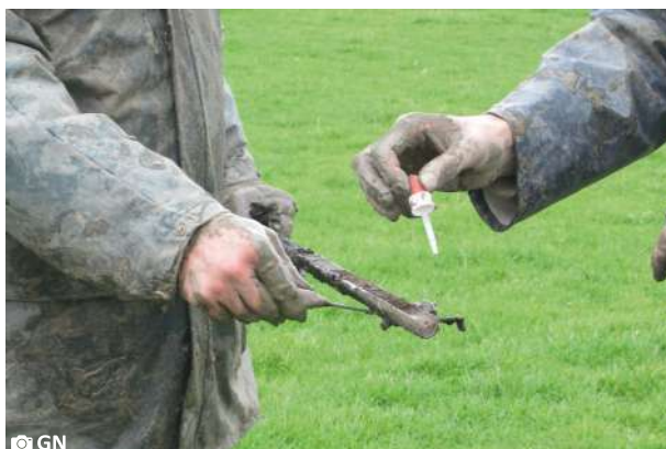
Fig. B41: Een gutsboorstaal wordt getest op de aanwezigheid van carbonaten door het toedienen van enkele druppels 10 % HCl. Saeftinghe, provincie Oost-Vlaanderen, België.
