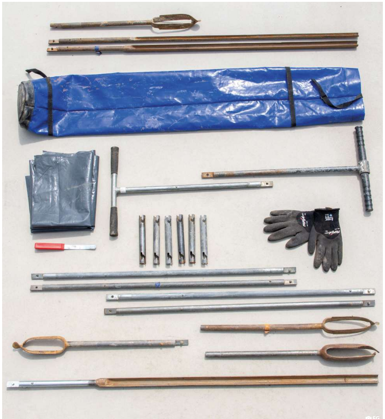
Fig. B38: Standaard handboorset met bajonetverbinding (onder de blauwe draagzak) uitgebreid met een kleiboorkop en twee gutsboren, lengte 100 cm en breedte 3 cm.
