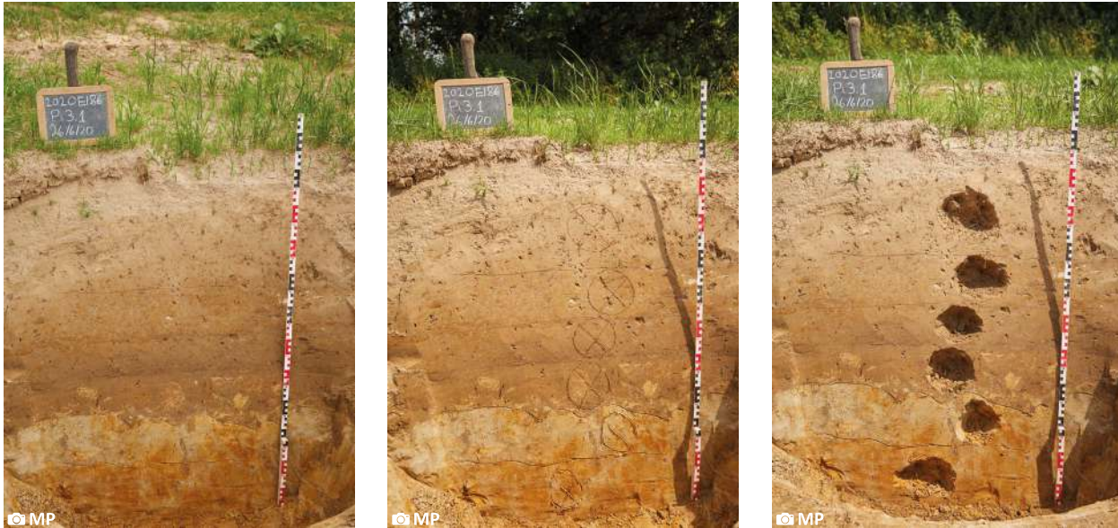
Fig. B124-B126: Foto van een bodemprofiel: opgekuist (fig. B124), met aanduiding van de horizonten (fig. B125) en na staalname (fig. B126). Sint-Gillis-Waas, provincie Oost-Vlaanderen, België.
