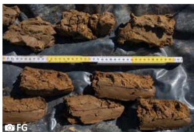
Fig. B76-B78: De boorkluiten worden volgens de diepte op het zeil gelegd (fig. B76). Daarna worden de kluiten in twee helften opengesneden om zicht te krijgen op het ongecontamineerde bodemmateriaal (fig. B77). Bij kleirijke horizonten zal het nodig zijn om de kluit met een mes in twee te snijden (fig. B78). Berg, Tongeren, provincie Limburg, België.
