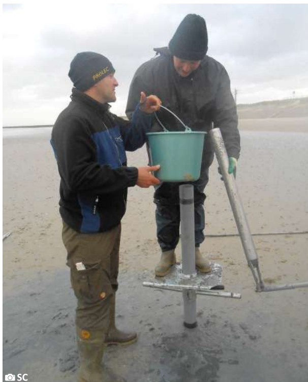
Fig. B35: Pulsboor en verbuizingssysteem om in waterverzadigd zand te kunnen boren. Strand, Mariakerke, provincie West-Vlaanderen, België.
