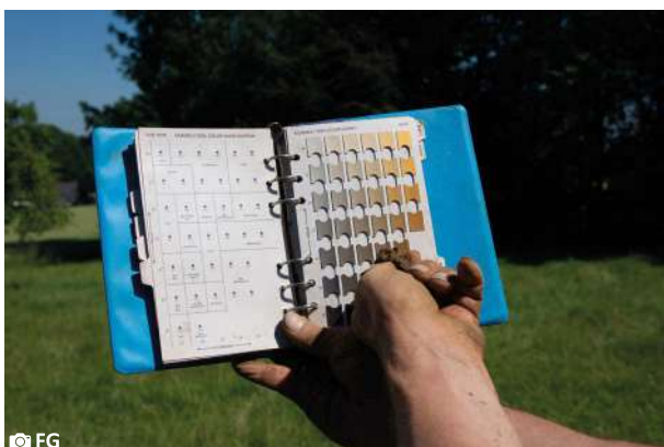
Fig. B39-B40: Gebruik van Munsell kleurenkaart. Een stuk aarde wordt gehouden voor de kleurchips en de beste match gezocht.
