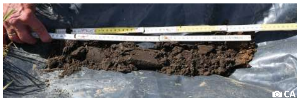
Fig. B79-B80: Met een tweede vouwmeter wordt regelmatig de boordiepte gecontroleerd (fig. B79). De gemeten boordiepte wordt vergeleken met het opgeboorde materiaal, desnoods wordt het opgeboorde materiaal samengedrukt of uitgespreid om overeen te komen met de effectieve boordiepte (fig. B80).
