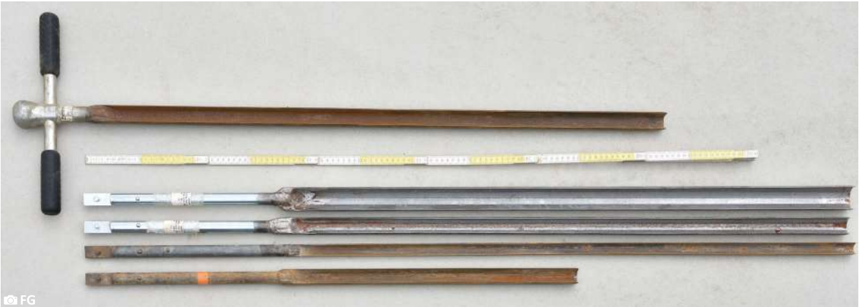
Fig. B36: Gutsboor met slagkop, boorkoppen met lengte 100 cm voor een gutsboor met diameter 4, 3 en 2 cm; gutsboor diameter 3 cm met lengte boorkop 50 cm.
