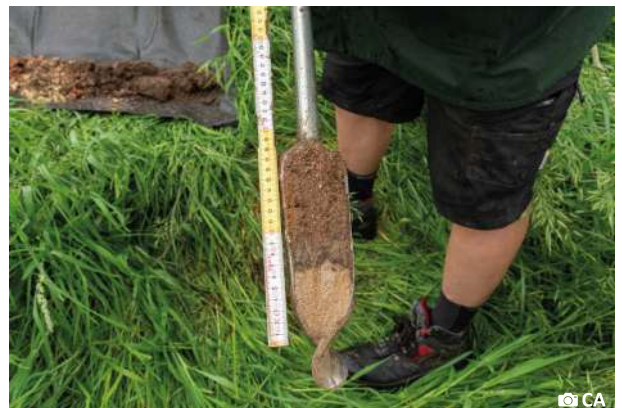
Fig. B17-B20: Het belangrijkste veldbodemmateriaal. Fig. B17: Schop, schop recht geslepen, spade, Hongaarse spade, truweel. Fig. B18: detail van de schop met of zonder recht geslepen einde. Fig. B19: Meetlint en vouwmeter. Fig. B20: De combiboorkop is 18 cm lang.
