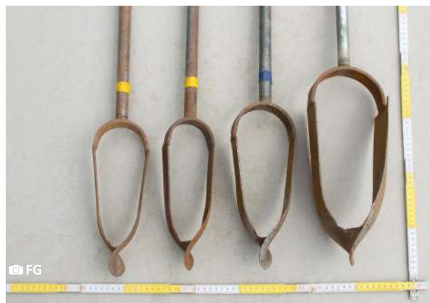
Fig. B34: Boorkoppen kunnen een verschillende diameter hebben, gaande van 7 tot 15 cm.
