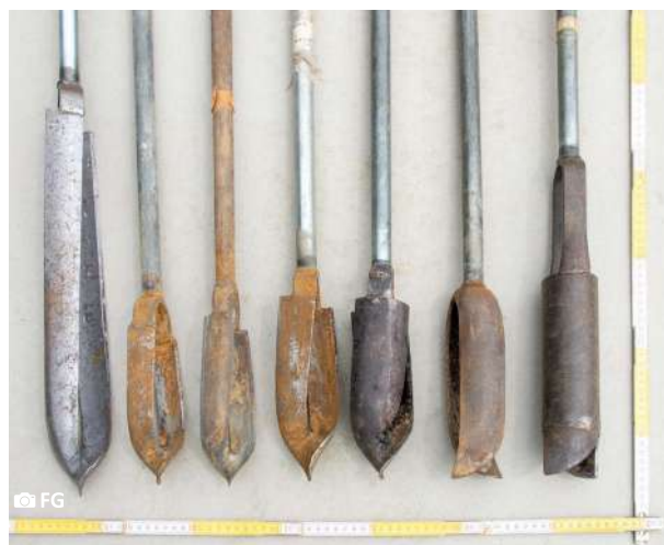
Fig. B33: Verschillende types van boorkoppen, gaande van links naar rechts: boor voor zachte klei, kleiboor, combiboor, zandboor, grof zandboor, grintboor, riversideboor.
