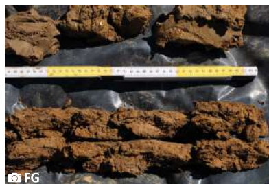
Fig. B76-B78: De boorkluiten worden volgens de diepte op het zeil gelegd (fig. B76). Daarna worden de kluiten in twee helften opengesneden om zicht te krijgen op het ongecontamineerde bodemmateriaal (fig. B77). Bij kleirijke horizonten zal het nodig zijn om de kluit met een mes in twee te snijden (fig. B78). Berg, Tongeren, provincie Limburg, België.
