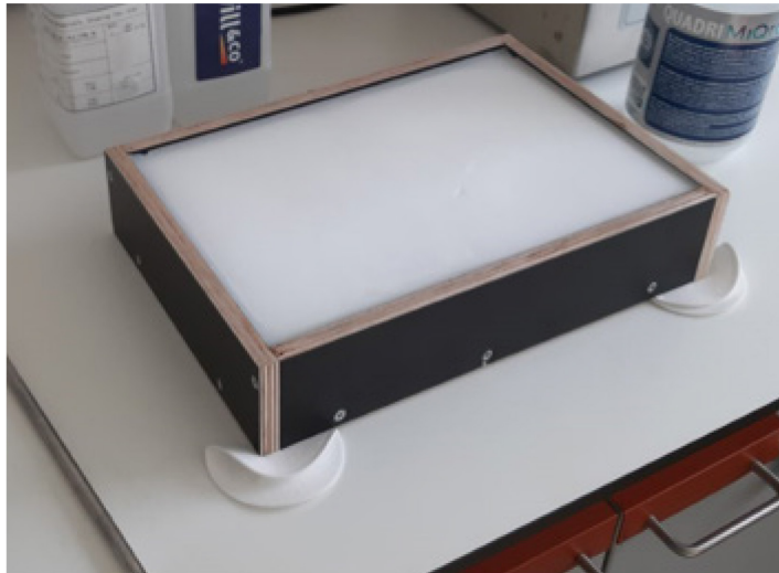
Figuur 2 – bekisting met gestolde PTMEG 2000 (witte kleur)
