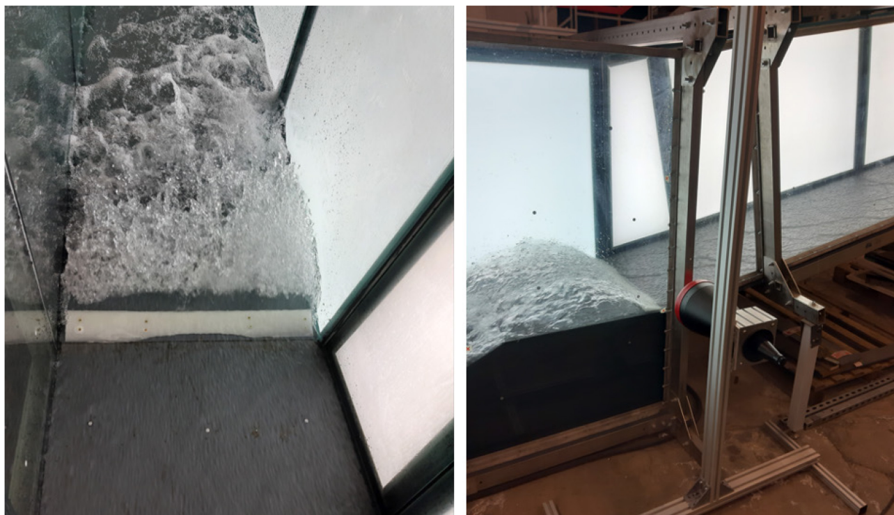
Figuur 16 – Drempel uit wax vast gemonteerd op de bodem van een stroomgoot. De drempel werd langdurig blootgesteld aan een debiet van 20 l/s.
