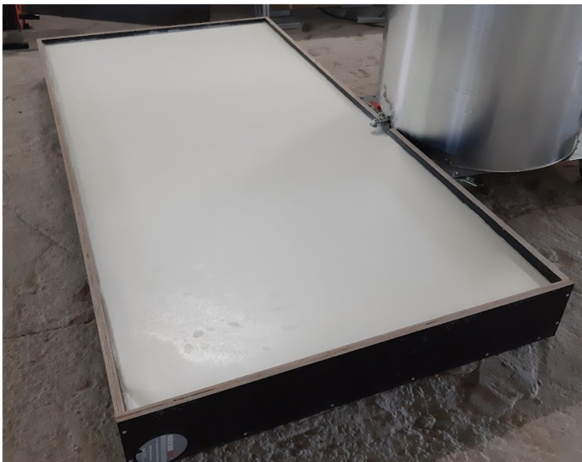
Figuur 9 – Bekisting van +/- 2m x 1m x 0.2m gevuld met uitgeharde wax. De wax werd gestort vanuit de smeltketel (rechts)
