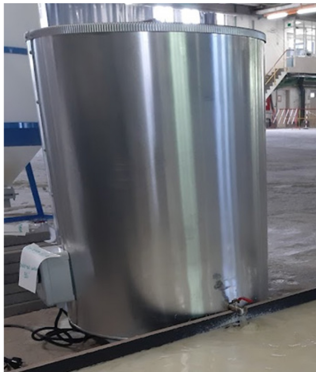
Figuur 8 – SH200 smeltketel van Sellacq Holland. Merk de vlotte (waterachtige) uitstroom van vloeibare wax op.
