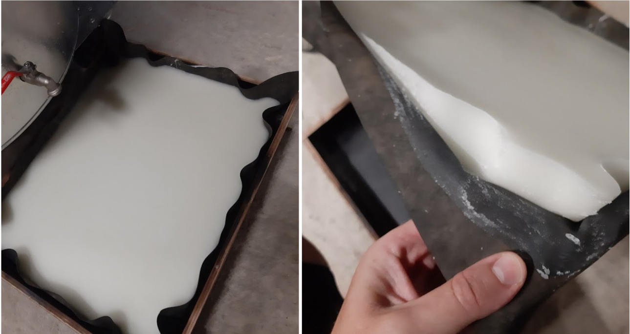
Figuur 10 – Experiment met EPDM als bekistingsmateriaal. De foto links toont aan dat met EPDM een meer willekeurige vorm gegeven kan worden aan de wax. De foto rechts toont bijkomend aan dat de EPDM eenvoudig van de wax gepeld kan worden.
