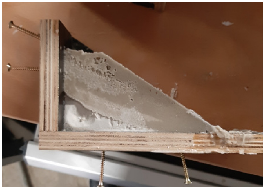
Figuur 15 – Een zand talud verzadigd met wax.
