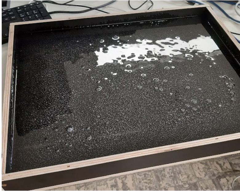
Figuur 4 – Gesmolten CAPA6500. De ingesloten luchtballen zijn duidelijk zichtbaar.
