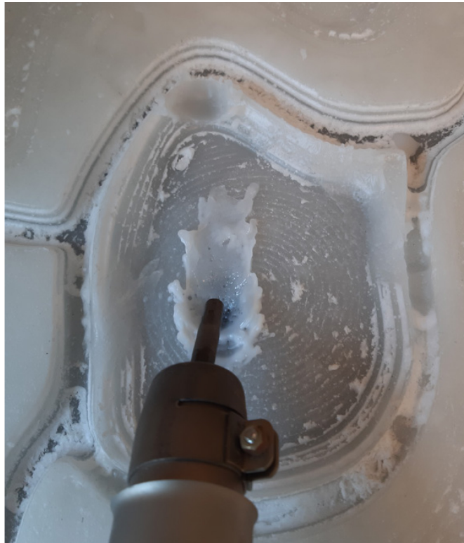
Figuur 6 – Smelten van wax met een heat gun. Gesmolten wax stolt direct nadat het de hete lucht straal heeft verlaten. Resultaat is zoals een bevroren fontein van water (niet goed te zien op de foto).
