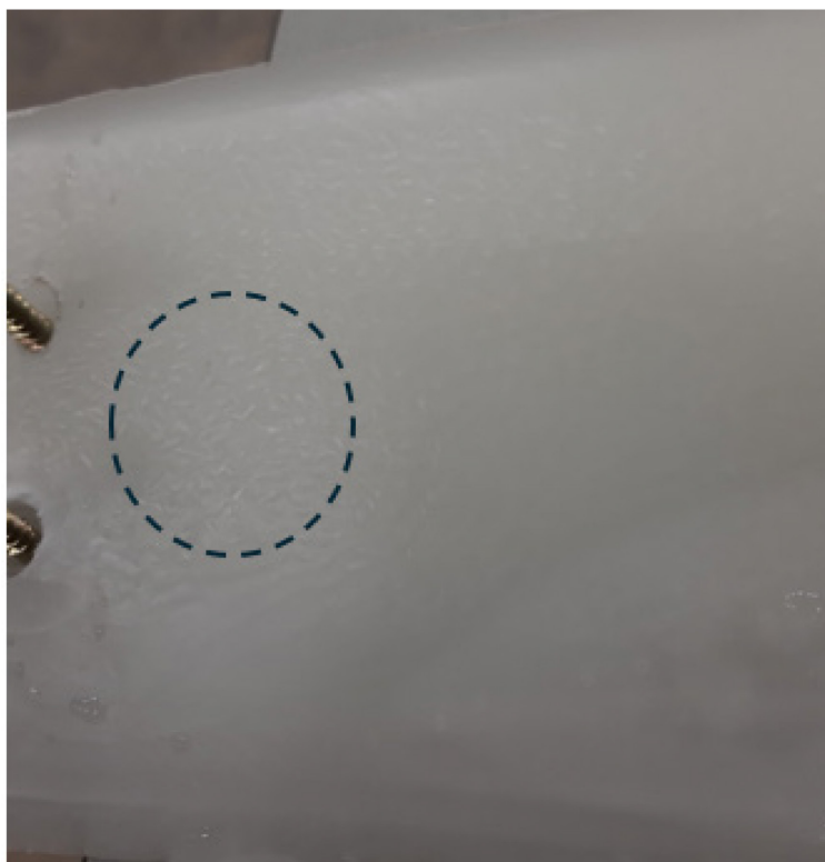
Figuur 17 – Reliëf op het vrije oppervlak van de wax ten gevolge van het uithardingsproces.
