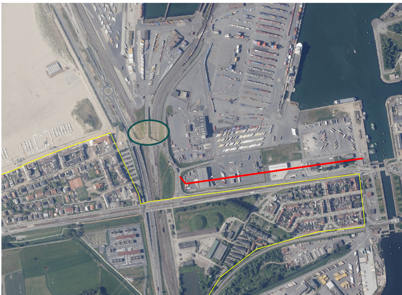
Figuur 1 – Luchtbeeld interessegebied met aanduiding van de veiligheidslijn (geel) en reeds gebouwde stormmuur (rood). De onderdoorgang van de spoorlijnen met de New Yorklaan is omcirkeld.
