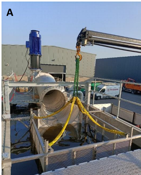
Foto 2: (A) Testopstelling met stroomafwaarts van de pomp een kooi die de vissen opvangt en (B) de kooi met afmetingen 2x2 m.
