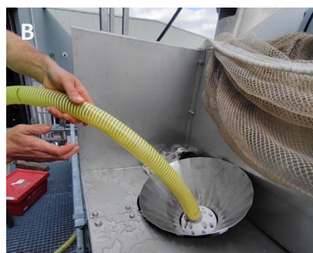
Foto 4: (A) Invoer van de proefdieren in de pompkelder via een trechter en (B) de flexibele buis met verbreed uiteinde om achtergebleven vissen richting de pomp te geleiden.
