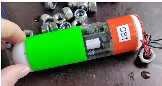
Foto 7: Voorbeeld van een BDS-sensor van de Universiteit van Tallinn.
