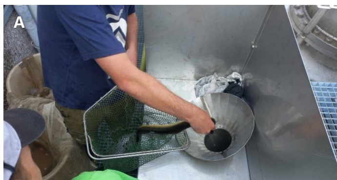
Foto 4: (A) Invoer van de proefdieren in de pompkelder via een trechter en (B) de flexibele buis met verbreed uiteinde om achtergebleven vissen richting de pomp te geleiden.
