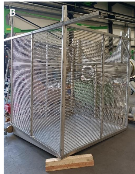
Foto 2: (A) Testopstelling met stroomafwaarts van de pomp een kooi die de vissen opvangt en (B) de kooi met afmetingen 2x2 m.
