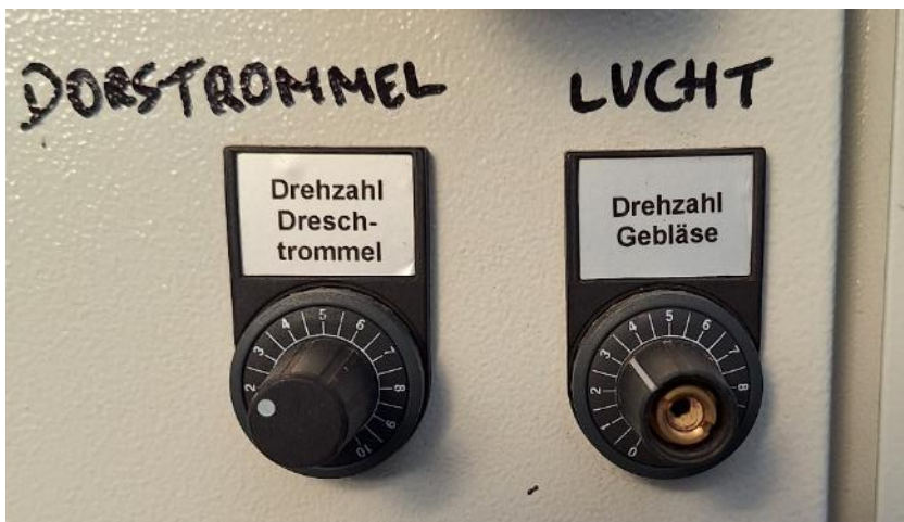
Foto 30: Op de dorser kan de draaisnelheid en de luchtsnelheid geregeld worden via twee regelaars volgens een schaal van 0 tot 10.
