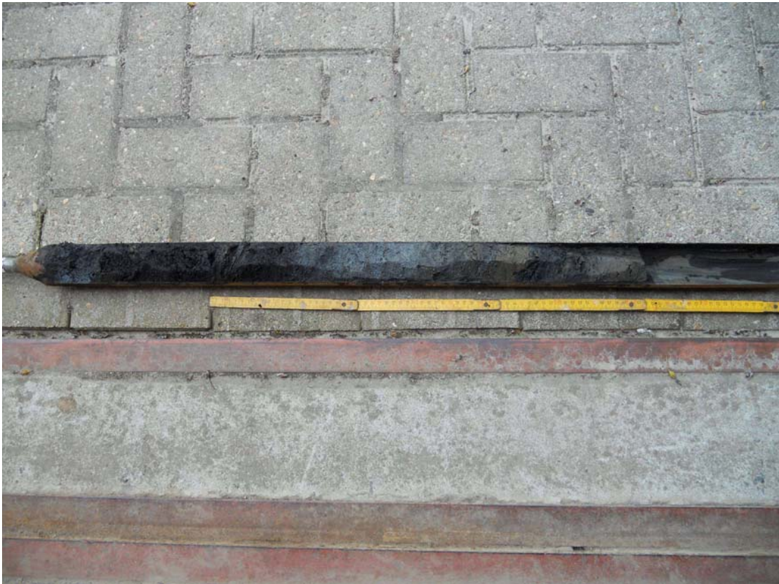
Foto 3.2b: het onderste gedeelte in de brede gutsboor.
