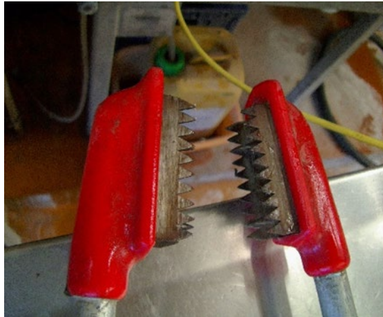
Figuur 3.7: De elektroden van de tang mogen niet roestig zijn.
