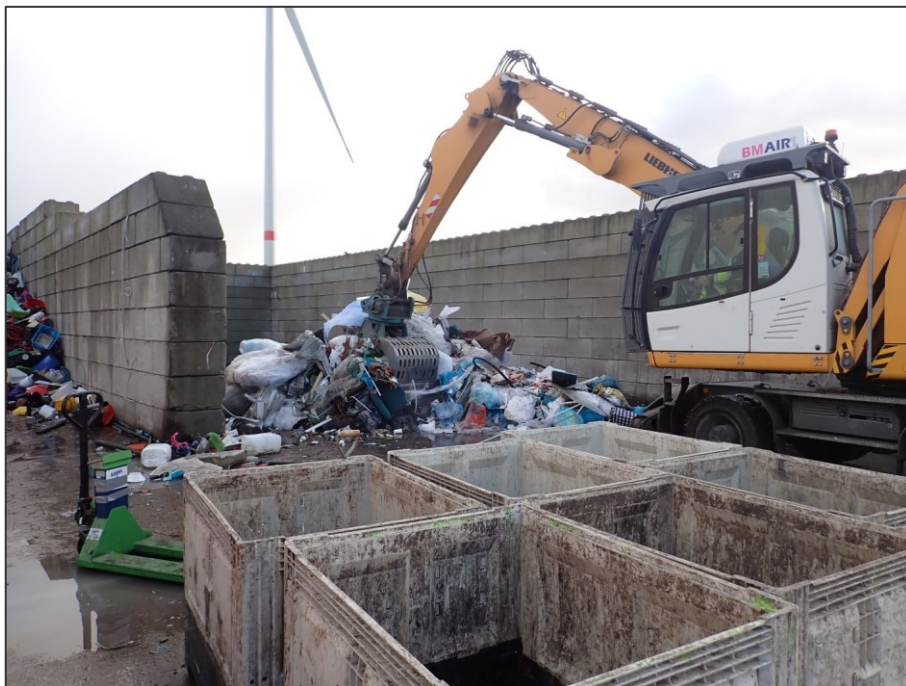
Figuur 4: Voorbeeld van set-up van de recipiënten voor uitsortering.
