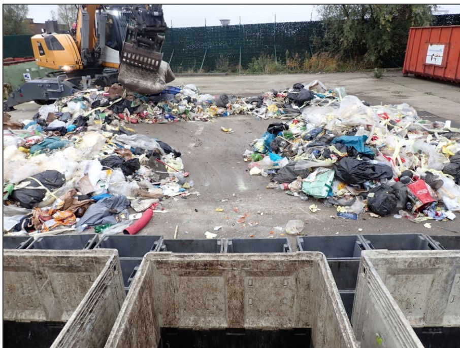
Figuur 3: Voorbeeld van de techniek menging-kwartering-reducering tijdens de sorteeraanalyse
