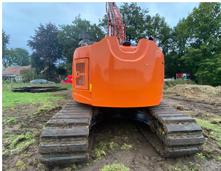
Links: rupskraan uitgerust met rubber op de rupsen
