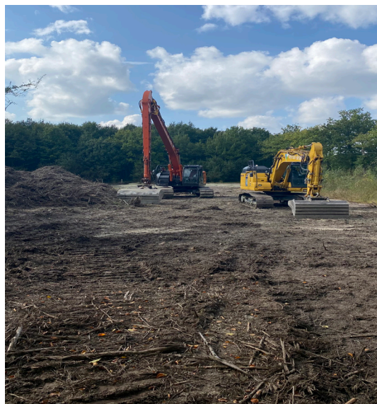
Gewone (rechts) en longreachrupskraan (links) Longreachkraan met kantelbare bak
