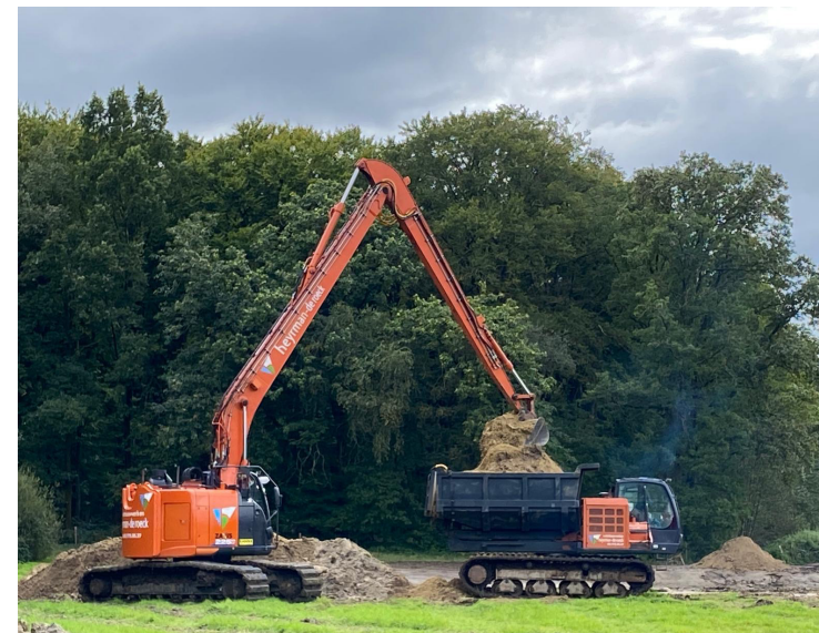
Gewone (rechts) en longreachrupskraan (links) Longreachkraan met kantelbare bak
