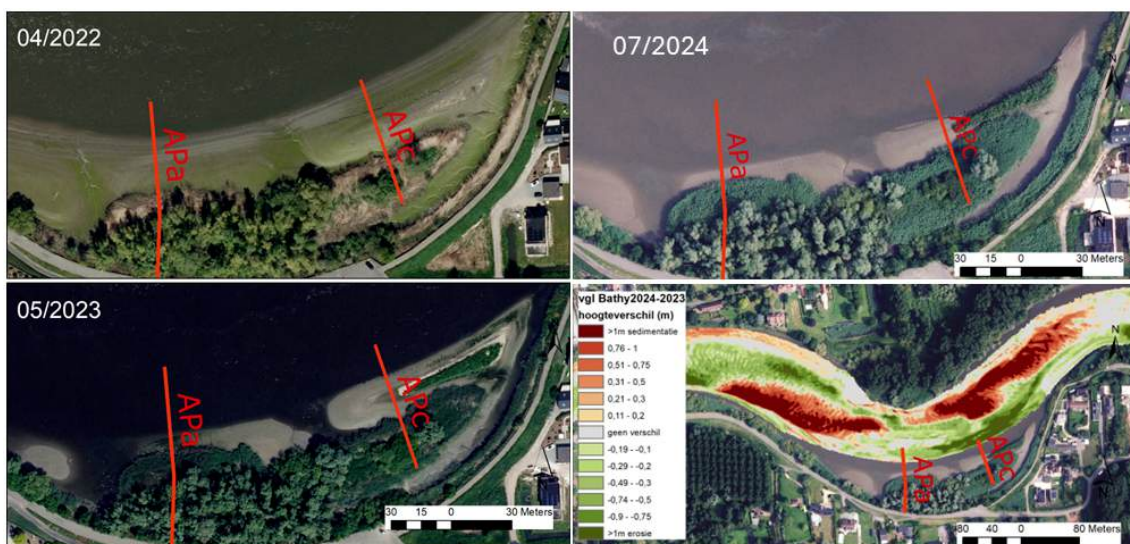
Figuur 12.45: Vergelijking van de schor- en slikevoluties aan Appels tussen 2022 en 2024 met erosie in NO en rechtsonder de sterke bodemverschillen in de hoofdgeul.
