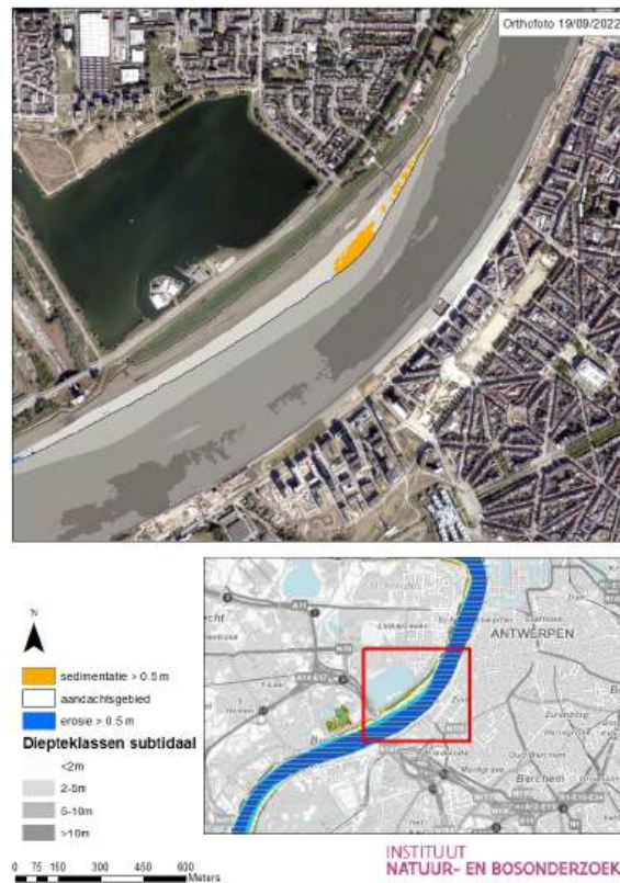
Figuur 13.11: Galgenweel - erosie en sedimentatie (2021/2022 - 2023). Correctie van Figuur 1.4 in de vorige MONEOS rapportage (Van Ryckegem et al., 2024).
