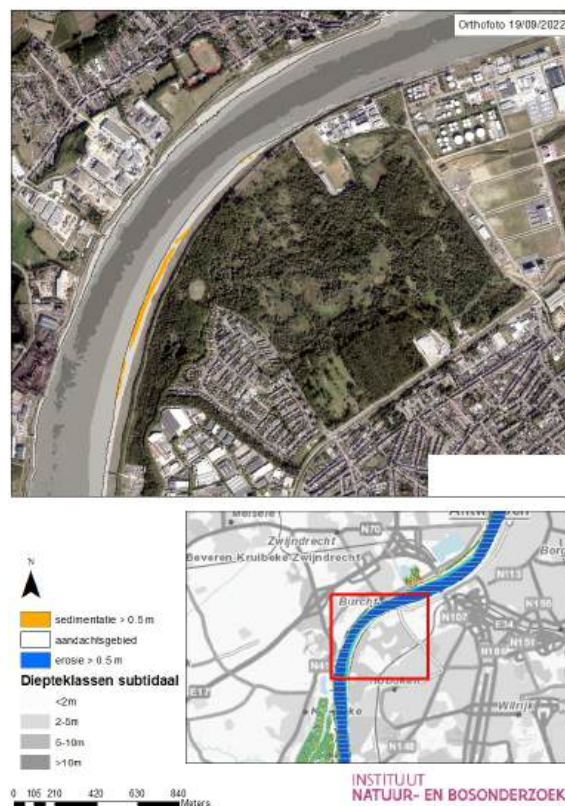
Figuur 13.12: Hoboken - sedimentatie zone (2022 - 2023). Correctie van Figuur 1.5 in de vorige MONEOS rapportage (Van Ryckegem et al., 2024).
