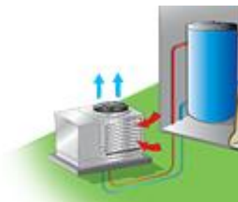
Figuur 194: Schematische voorstelling van een lucht/water koude-opwekker
