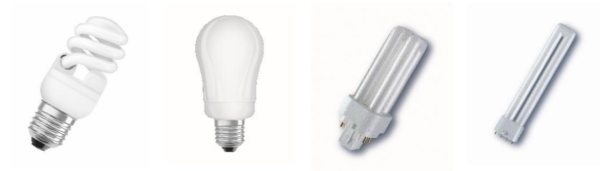
Figuur 255: Compacte TL-verlichting met geïntegreerde ballast tubevormig (uiterst links) en ballonvormig (links) en compacte TL-verlichting met externe ballast tubevormig (rechts en uiterst rechts)
