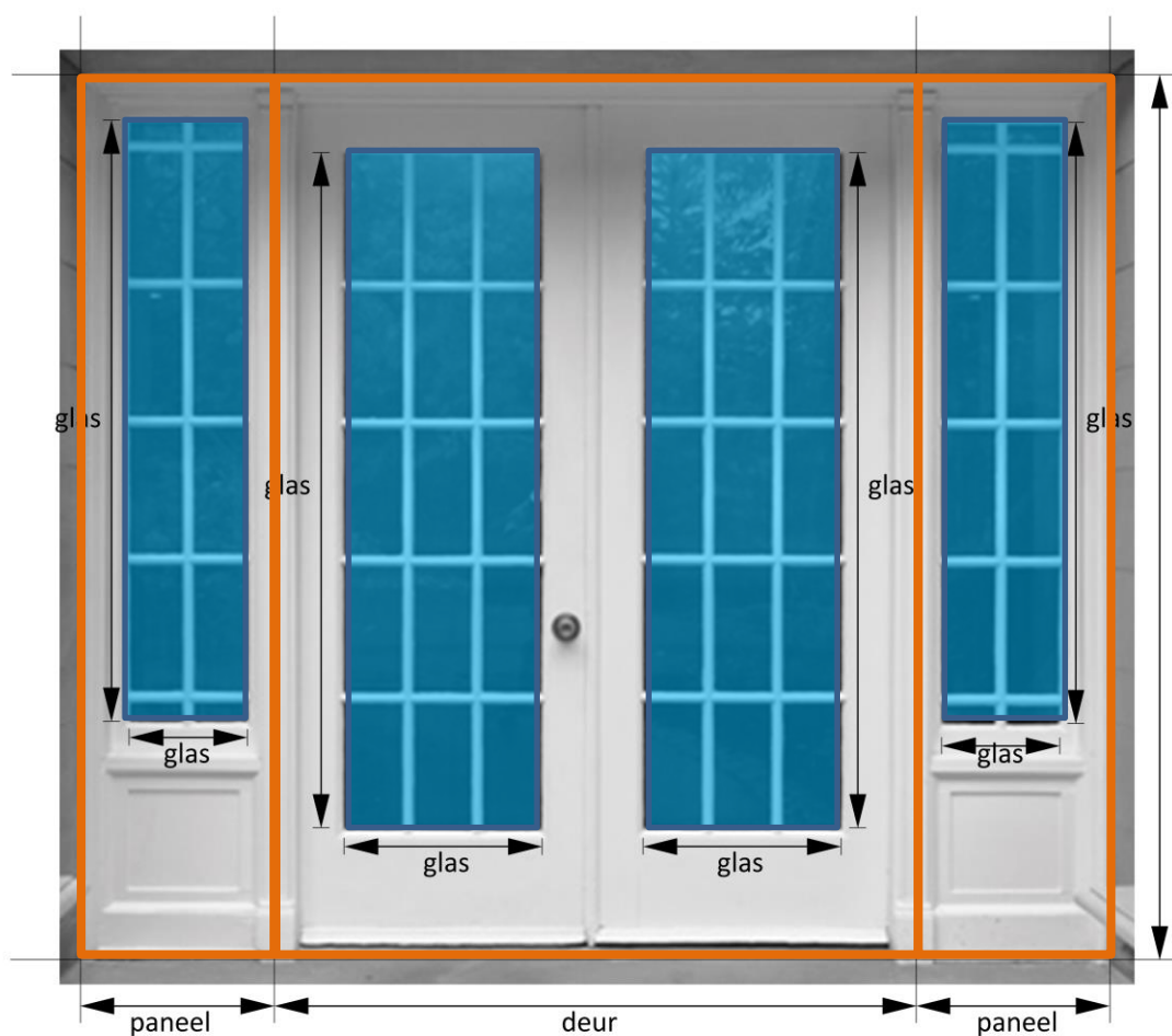
Figuur 48: Voorbeeld van een opening bestaande uit zowel deur (met glas) als paneel (met glas). De panelen (de vaste delen links en rechts zonder de beglazing), de deuren (de opengaande opake delen in het midden zonder de beglazing) en de beglazingen worden elk apart ingevoerd in de software. Het glas is hier niet vastgezet met aparte profielen en is ingewerkt in de dikte van het hout à type profiel 'geen'.
