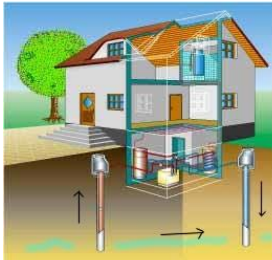
Figuur 195: Schematische voorstelling van een water/water koude-opwekker.
