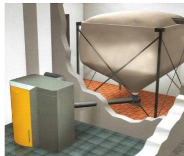
Pelletopslag in een afzonderlijke ruimte met automatische schroefaanvoer
