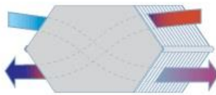
Figuur 227: Principe van warmterecuperatie
