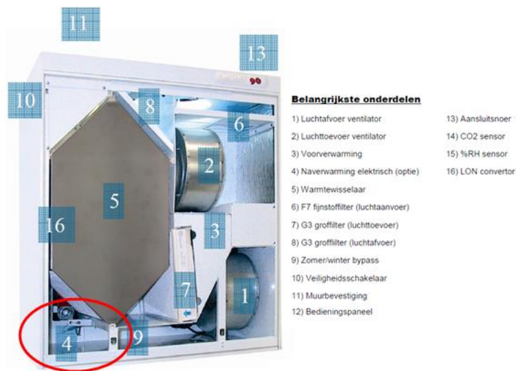
Figuur 156: Luchtgroep voor balansventilatie (met warmteterugwinning) met ruimte voor optionele elektrische weerstand
