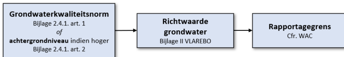
Figuur 3: Te volgen toetsingskader voor het weer in de ondergrond brengen van gevaarlijke stoffen, met verwijzingen naar relevante wetgeving.
