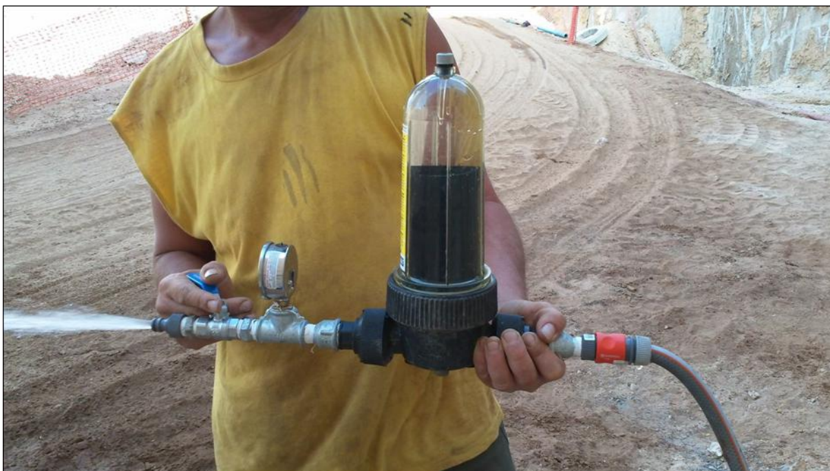
Figuur 25: Illustratie van het meten van de ontgassingsdruk.
