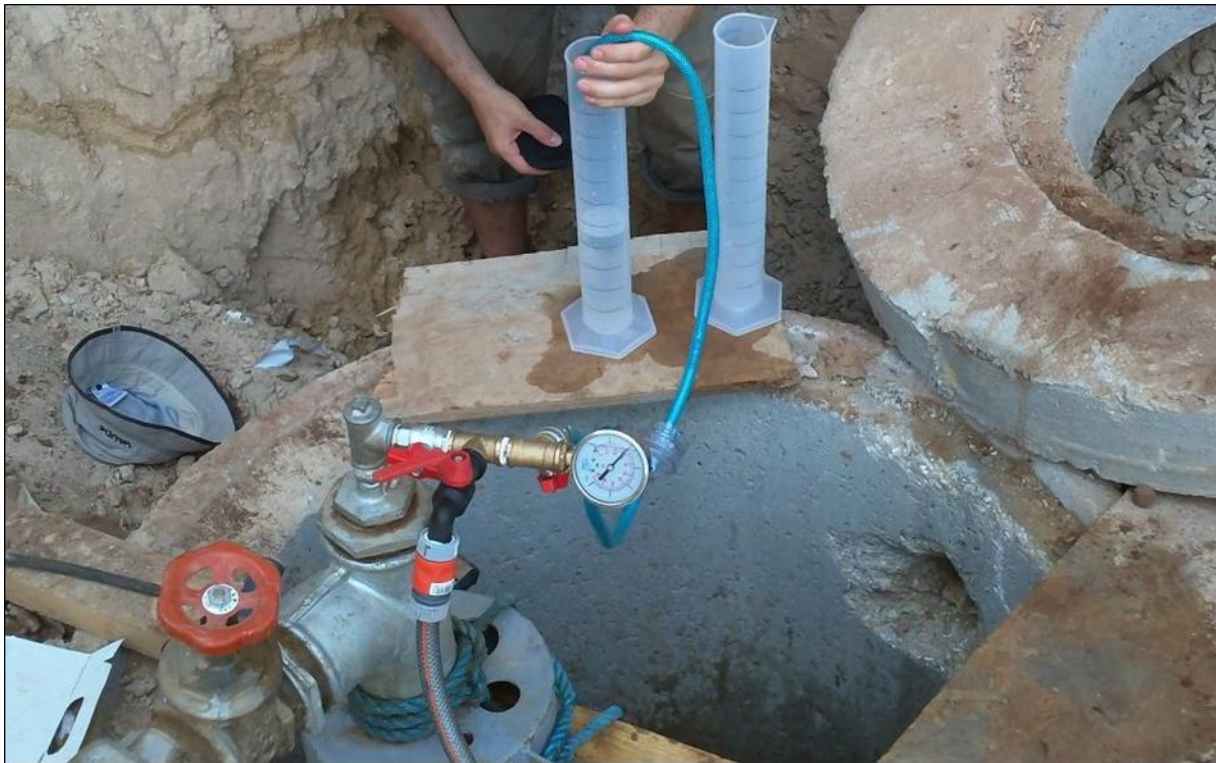
Figuur 26: Illustratie van een MFI-test op het terrein.
