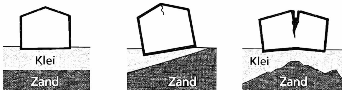
Figuur 2: Relatie tussen differentiële zettingen en de grondopbouw.
