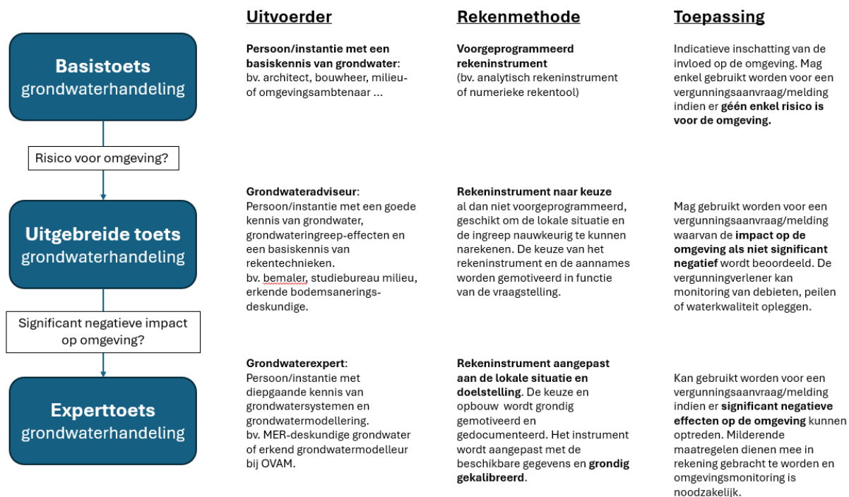
Figuur 7: Schema met de drie niveaus van impactbepaling en de voorwaarden naar uitvoering, gebruikte rekenmethode en toepassing.
