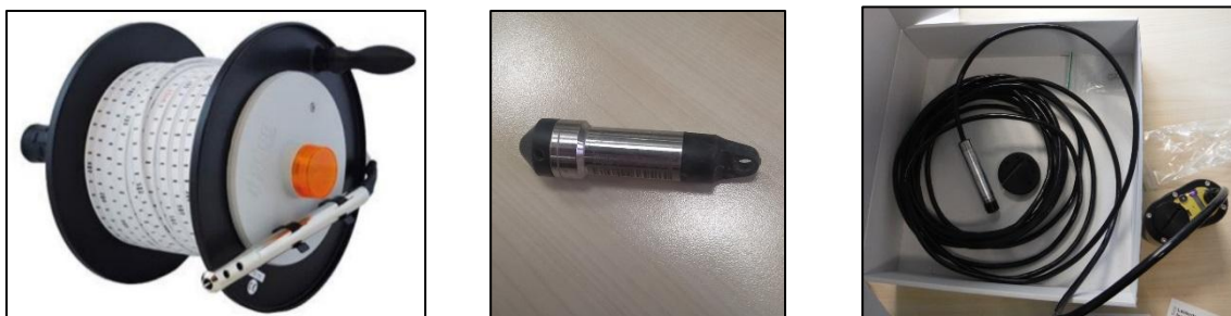
Figuur 6: Peilmeetlint (links) en dataloggers (offline midden of online rechts) voor het opmeten van de grondwaterstand.
