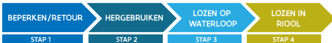
Figuur 1: De 4 stappen van de bemalingscascade.
