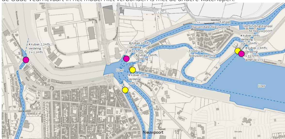
Figuur 2. Overzicht pompcapaciteit aan de Ganzepoot in Nieuwpoort tijdens hoogwaterperiode nov/2023 (bron: De Vlaamse Waterweg)
