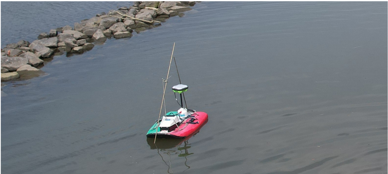
Figuur 11 – Fixatie ADCP in plasberm
