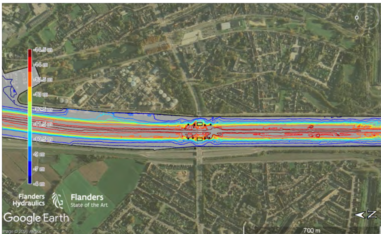
Figuur 17 – Weergave van de dieptelijnen uit het gecombineerde bodemprofiel te Brug Zelzate
