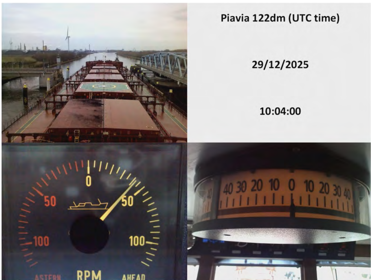
Figuur 10 – Weergave van de beelden gecapteerd door MIM_FH tijdens de meetreis (voorbeeld voor passage brug Sluiskil)
