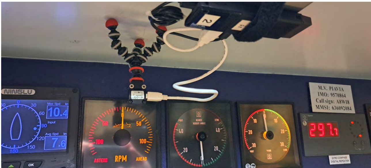
Figuur 9 – Illustratie van de camera unit voor captatie van het schroeftoerental
