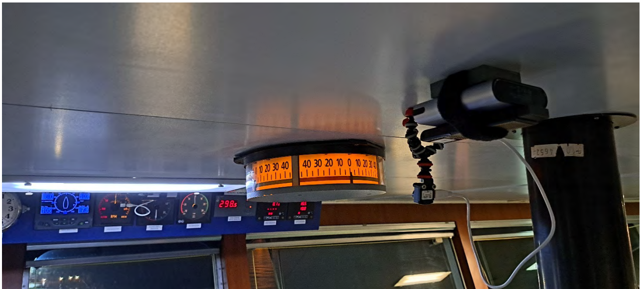
Figuur 8 – Illustratie van de camera unit voor captatie van de roerhoek
