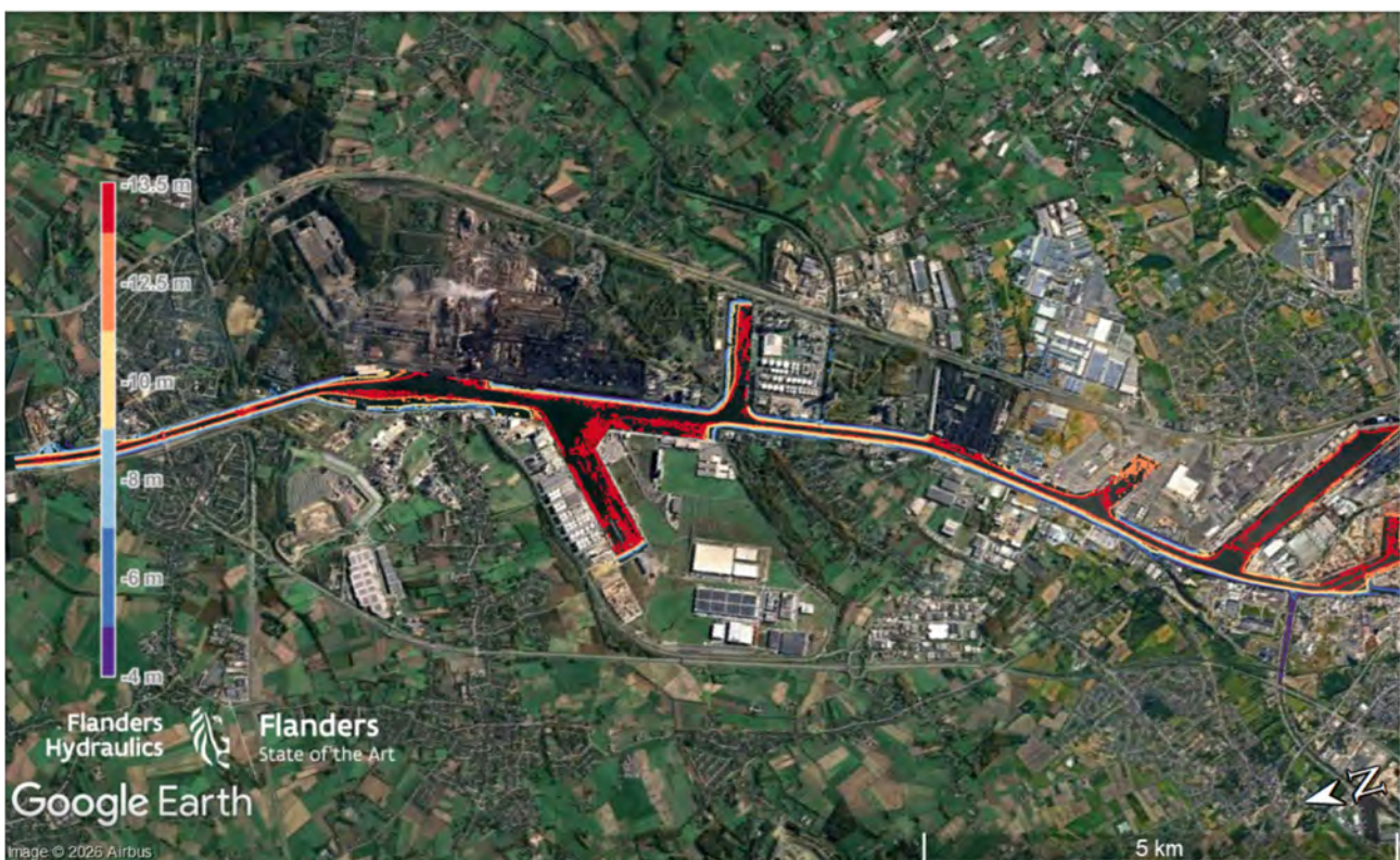
Figuur 13 – Weergave van de dieptelijnen bekomen uit peiling 251210_1216_KGT_MB (VL)
