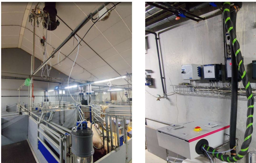
Figuur 7: Foto's van het meetpunt in de stal (links) en de Axetris-box (rechts).
