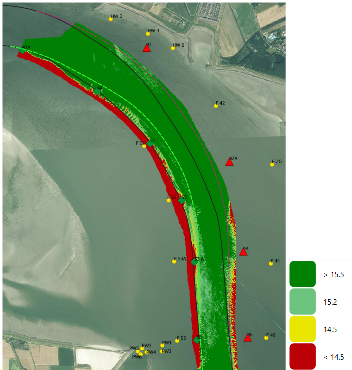
Figuur 14 – Diepteligging (in mLAT) ter hoogte van huidige en geoptimaliseerde vaargeulcontour
