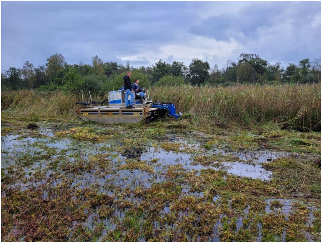
Figuur 21: In dit vochtige rietland vormt het amfibievoertuig met maaibalk geen brandgevaar voor de omgeving (foto: Tom Heylen)
