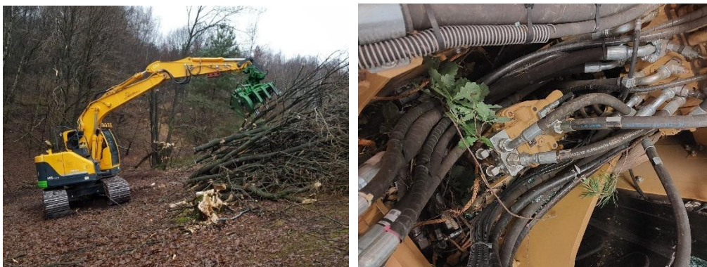
Figuur 14: links: Een kraanarm met grijper vormt op zich een gering brandrisico (foto: Tom Heylen); rechts: Opgehoopte twijgen tussen de hydraulische leidingen van een kraan (foto: Jonas Lequeu)
