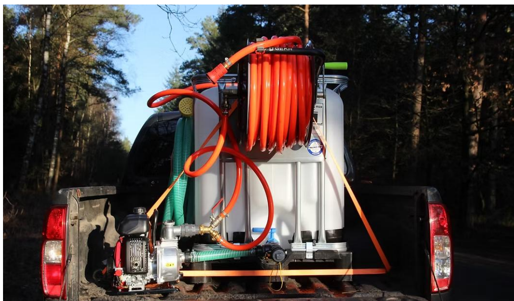
Figuur 22: De "Forst-Feld-Farm" blusmodule ontwikkeld binnen het WKR-project in Duitsland (foto: Alexander Held)
