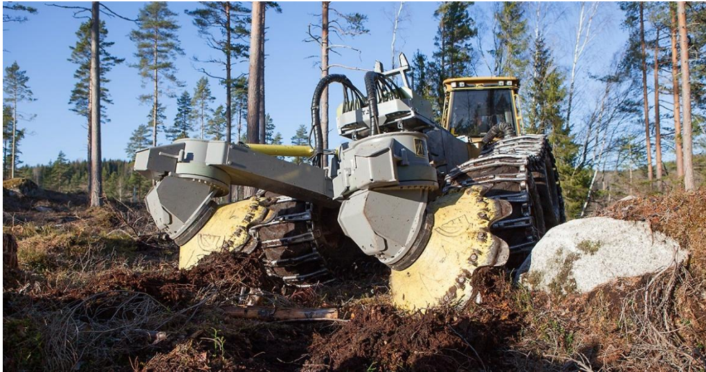
Figuur 8: Bosploeg (disc trencher) op een stenig terrein in Zweden, gevaar voor vonkslag (foto: Bracke Forest AB)
