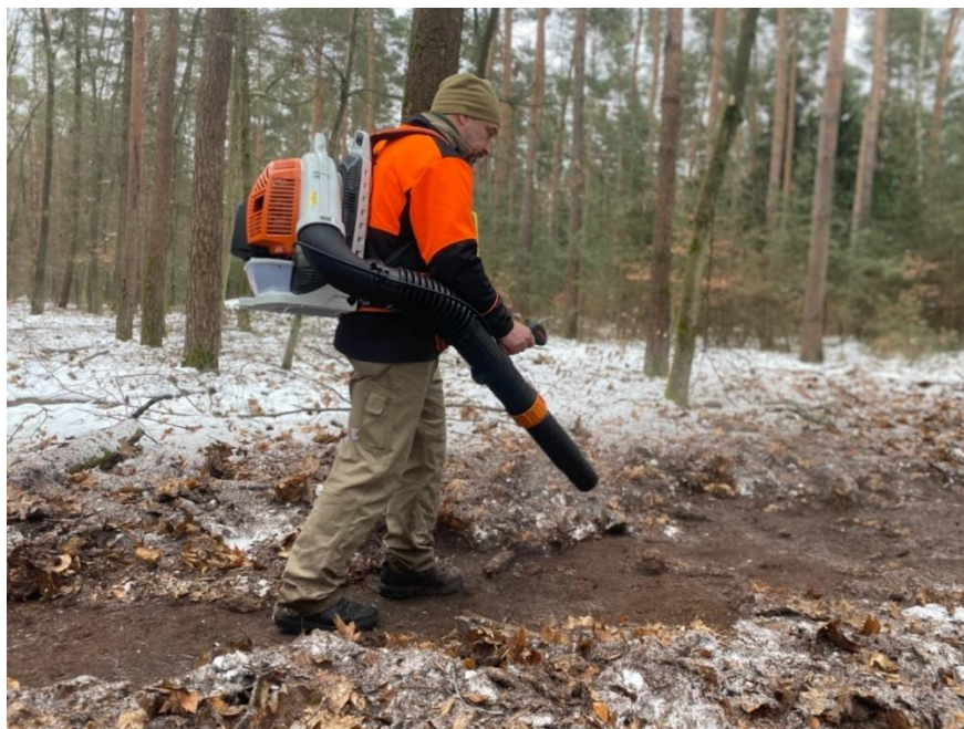
Figuur 24: Een bladblazer komt op tal van manieren van pas: om fijn strooisel weg te blazen, vlammen uit te blazen (tegen windrichting in) of de vlam van de brandstof te scheiden (foto: Maria Schloßmacher)
