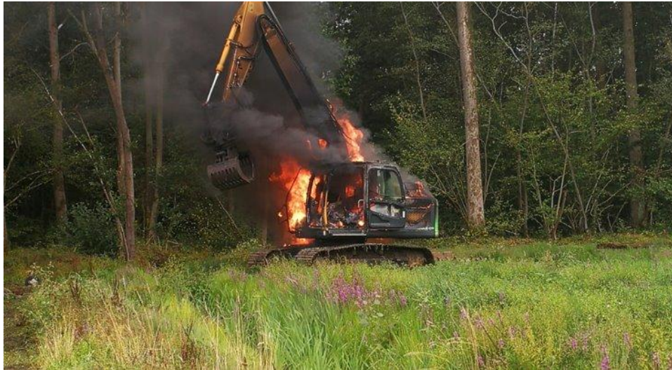
Figuur 16: Brand in een rupsgraafmachine in een vochtig grasland ten gevolge van een elektronisch defect (foto: Tom Heylen)
