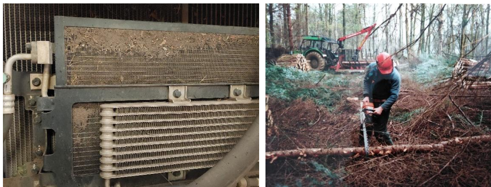
Figuur 10: links: Vervuilde motorradiator van een kraan (foto: Jonas Lequeu); rechts: Kettingzagen beschikken meestal nog steeds over een tweetakt-benzinemotor. Voor lichter werk zijn accumachines in opmars. (foto: Tom Heylen)
