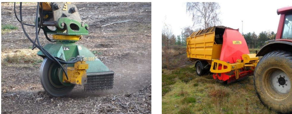
Figuur 17: links: Stronkenfrees in actie (foto: Tom Heylen); rechts choppermachine of klepelmaaier met uitworp in trailer (foto: Tom Heylen)
