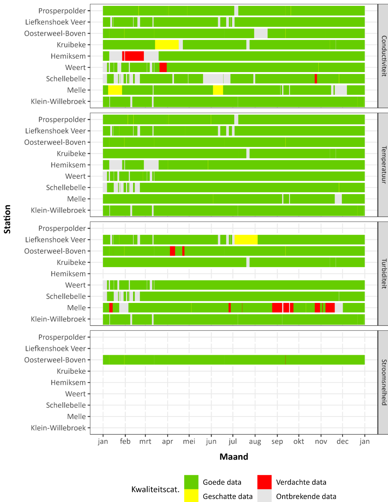
Figuur 119 – Overzicht van de datakwaliteit per parameter en per station voor de continue metingen fysische parameters (meetfrequentie 5 min) voor 2025. Voor Prosperpolder en Hemiksem is de frequentie van conductiviteit en temperatuur lager (10 min).
