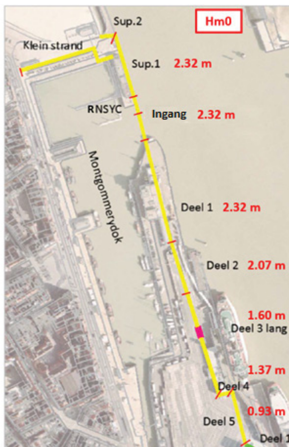
Figuur 2 – Ontwerpgolfhoogtes voor de zones RNSYC, ingang & Churchillkaai (1000-jarige storm met zeespiegelstijging +100 jaar, waterstand +7.87 m TAW).
