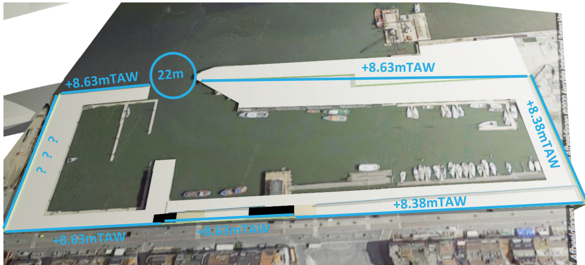
Figuur 11 – Kruinhoogte stormmuren rondom Montgomerydok om een storm met waterpeil +8.00 m TAW te keren.
