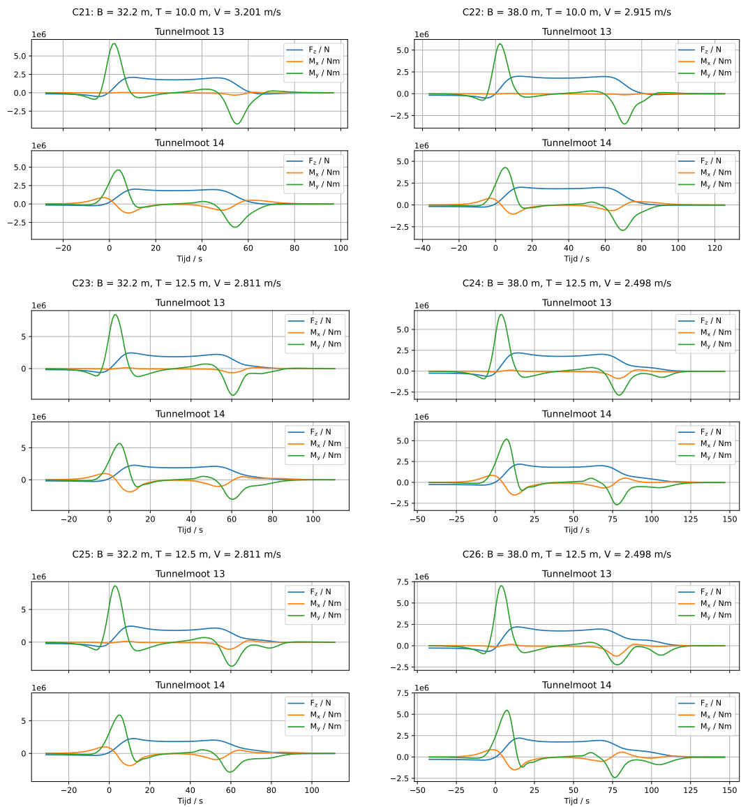
Figuur 48 – Verloop in de tijd van verticale kracht F_z en momenten M_x en M_y ten gevolge van de hydrodynamische belasting bij een scheepspassage voor cases 21 en 22 (sectie 1920) en 23 tot 26 (sectie 2015).
