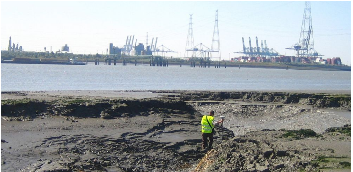
De afzetting van slib wordt met precisie-GPS gemeten
