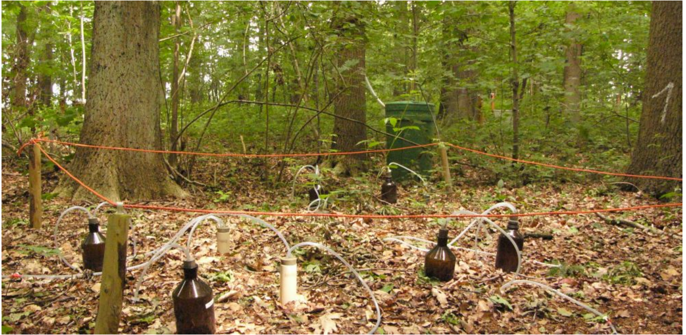
Collectoren voor bodemvocht en stamafvloeï
