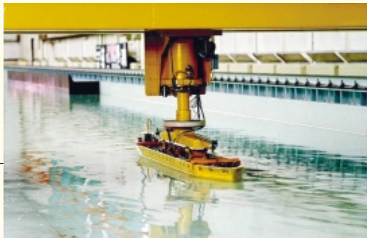
<<< een schaalmodel van een schip in de sleeptank
