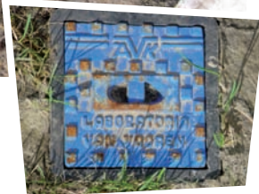
Controle van het grondwater met een peilbuis
