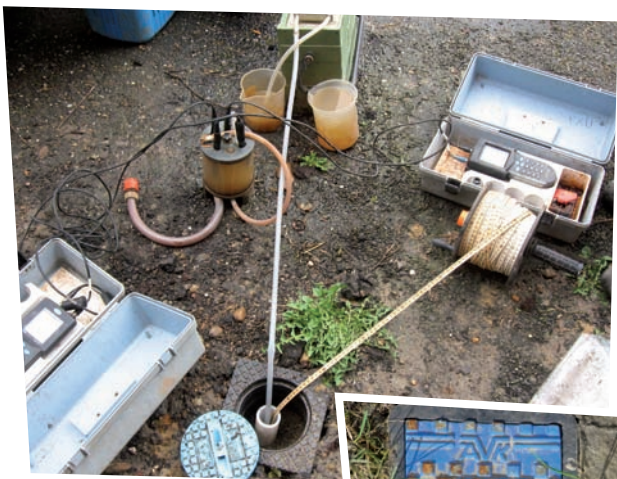
Controle van het grondwater met een peilbuis
