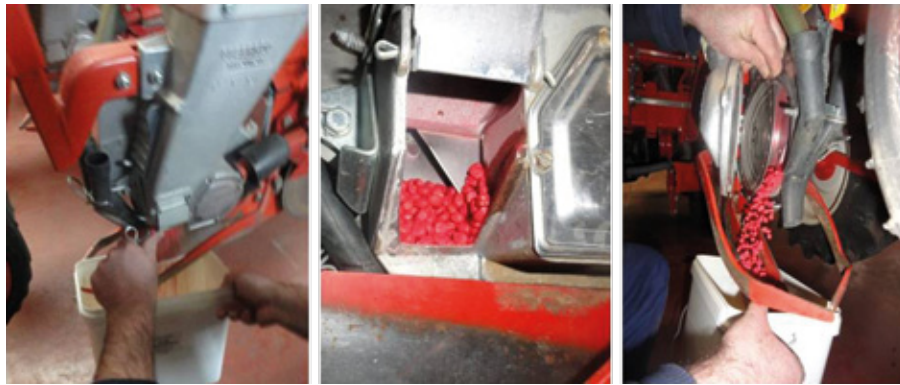
Figuur 6. Links: ledigen van zaaimachine - midden: achterblijvende korrels na ledigen volgens gangbare praktijk - rechts: ledigen van de zaaimachine door ook de zaadschijven los te schroeven zorgt ervoor dat alle resterende zaden ook uit de machine worden verwijderd
