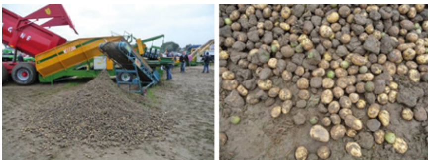
Figuur 7. Links: transport van de geoogste aardappels vanuit kipwagens over rollenzeef via transportband naar vrachtwagen voor transport naar opslagloods - rechts: detailbeeld van de fractie afgescheiden via de rollenzeef: naast aarde en stenen kan deze fractie duidelijk ook bessen en knollen bevatten
